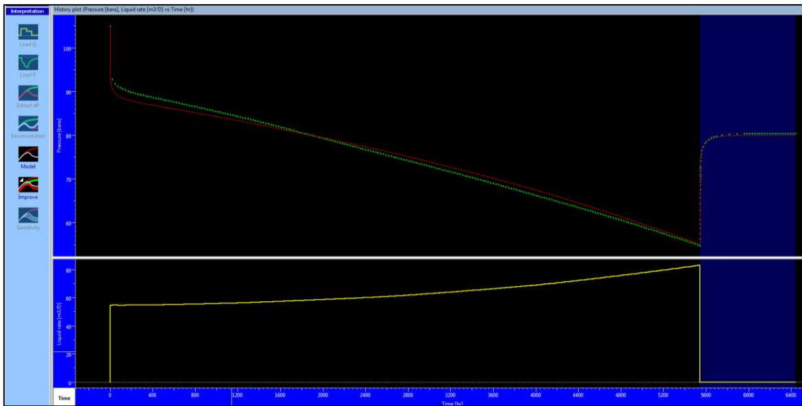
Slika 5-5. Poklapanje krivulje tlaka iz simuliranog testa u programu Eclipse (zeleno) i mećiranog tlaka (crveno)
