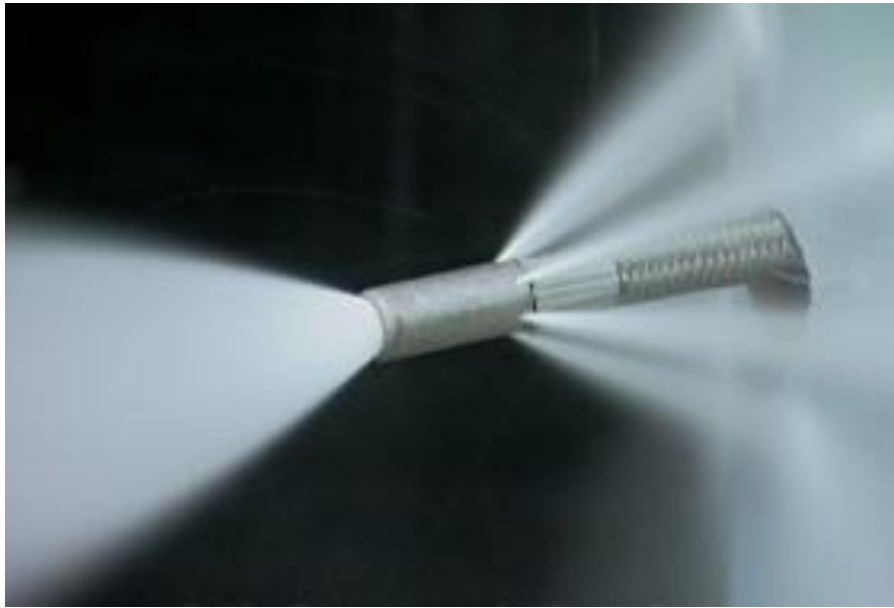
Slika 2-4. Buckmanova konusna mlaznica (Buckman Jet Drilling, 2003)
