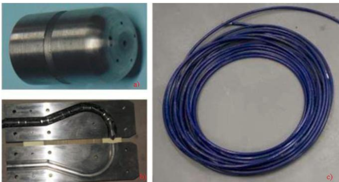
Slika 5-2. Mlazno dlijeto (a), usmjerivač (b) i visokotlačno crijevo (c) (Bin et al., 2016)
