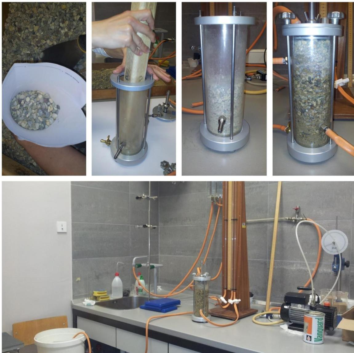
**Slika 4-11** Ugradnja uzorka u ćeliju
