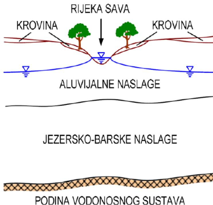
**Slika 2-4** Shematski profil zagrebačkog vodonosnog sustava (Posavec, 2006)
