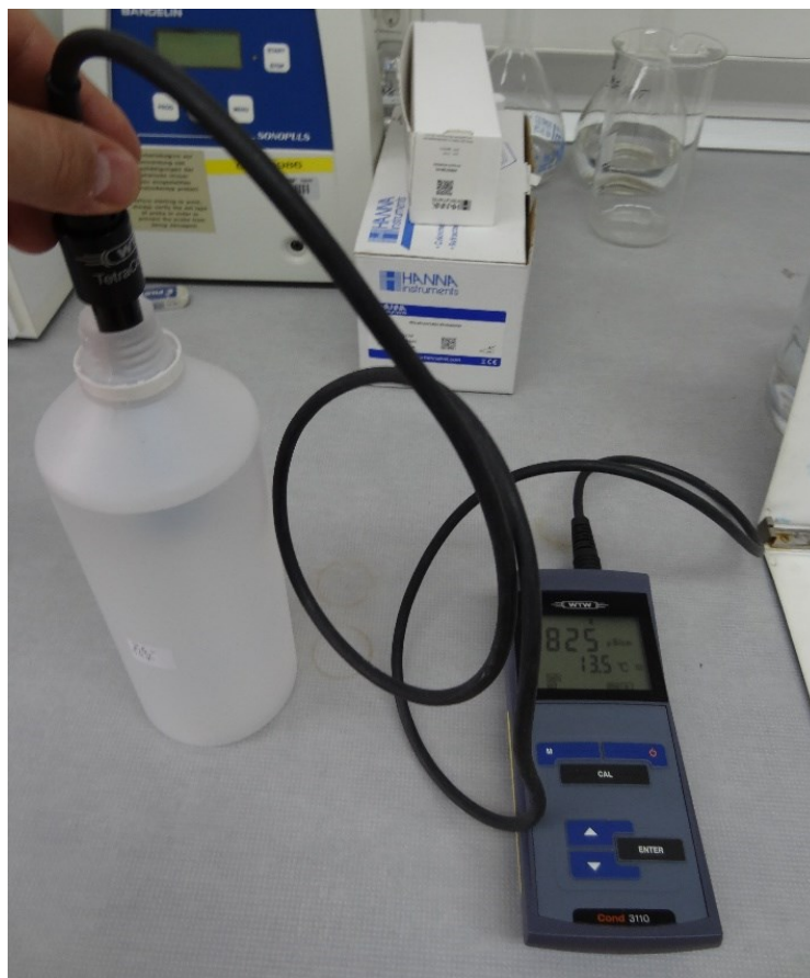
Slika 4.23. Mjerenje električne vodljivosti na uzorku ZG-14
