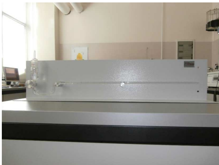
Slika 7-3 Uređaj za određivanje sposobnosti upijanja vode
