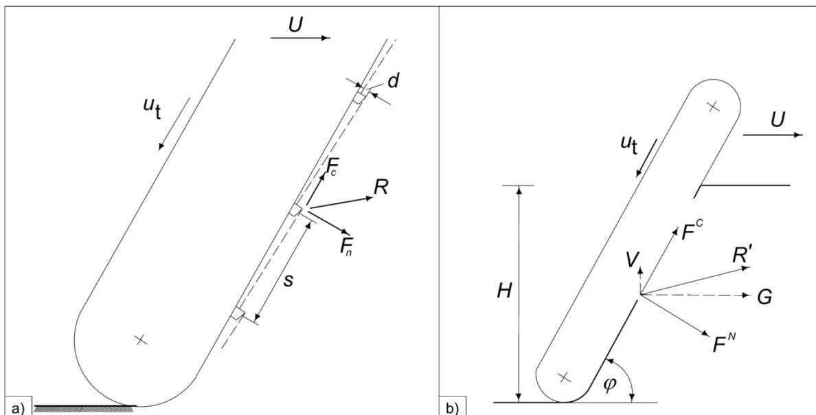
Slika 4.2. Raspodjela sila a) na reznim pločicama b) na maču (Mellor, 1978).
