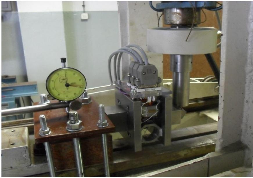
Slika 6.10. Uredaj za umjeravanje pretvornika sile.
