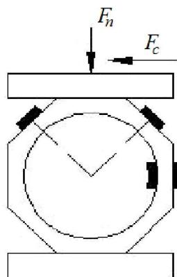
Slika 6.4. Položaj traka za mjerjenje deformacija na osmerokutnom prstenu (Saglam i Unuvar, 2001).
