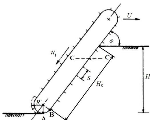
Slika 4.1. Simboli korišteni pri analizi kinematike lančane sjekačice (Mellor, 1976).
