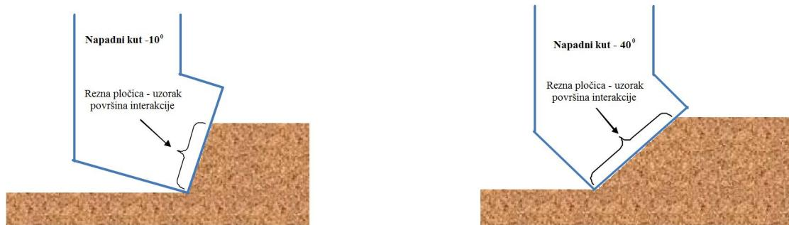
Slika 5.5. Povećanje površine kontakta stijene i rezne pločice uslijed povećanja napadanog kuta Rajabov et al. (2012).
