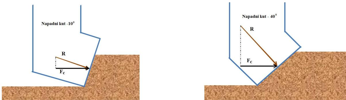
Slika 5.6. Povećanje resultantne sile uslijed povećanja napadanog kuta Rajabov et al. (2012).
