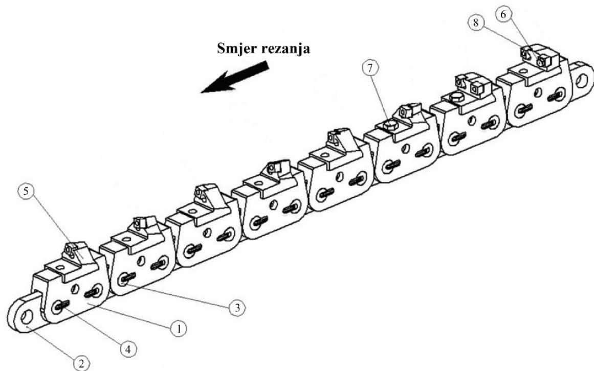
Slika 2.3. Segment reznog lanca lančane sjekačice (Sariisik, 2000).
