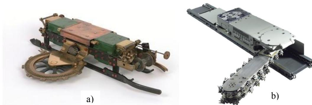
Slika 2.1. Stara rudarska podsjekačica a) sa ozubljenim kotačem b) sa ozubljenim lancem (NCMME, 2013).
