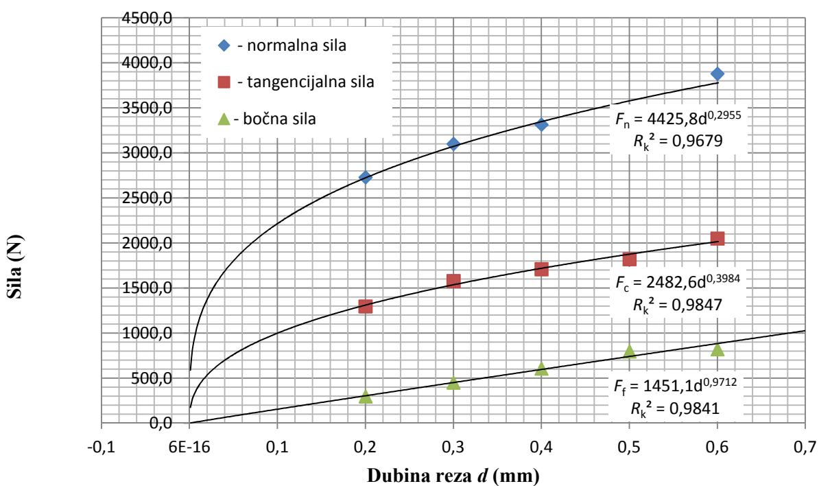
Slika 6.20. Zavisnost tangencijalne, bočne i normalne sile o dubini rezanja.
