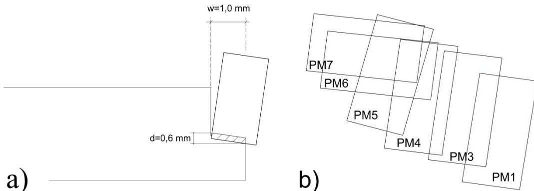
Slika 6.29. a) postupak ispitivanja, b) raspored reznih pločica za ispitivanje.
