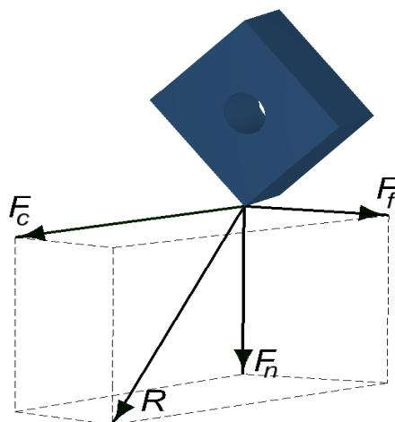
Slika 3.1. Rezultantna sila rezanja i njene komponente.
