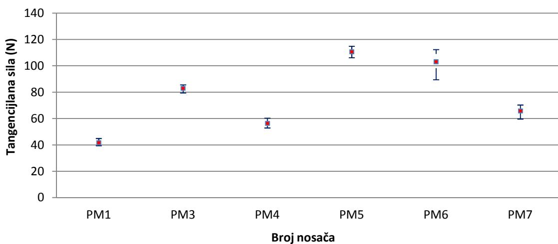
Slika 6.30. Raspodjela tangencijalnih sila za pojedinačne nosače.
