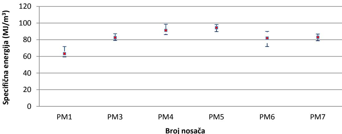
Slika 6.32. Raspodjela specifične energije rezanja za pojedinačne nosače.
