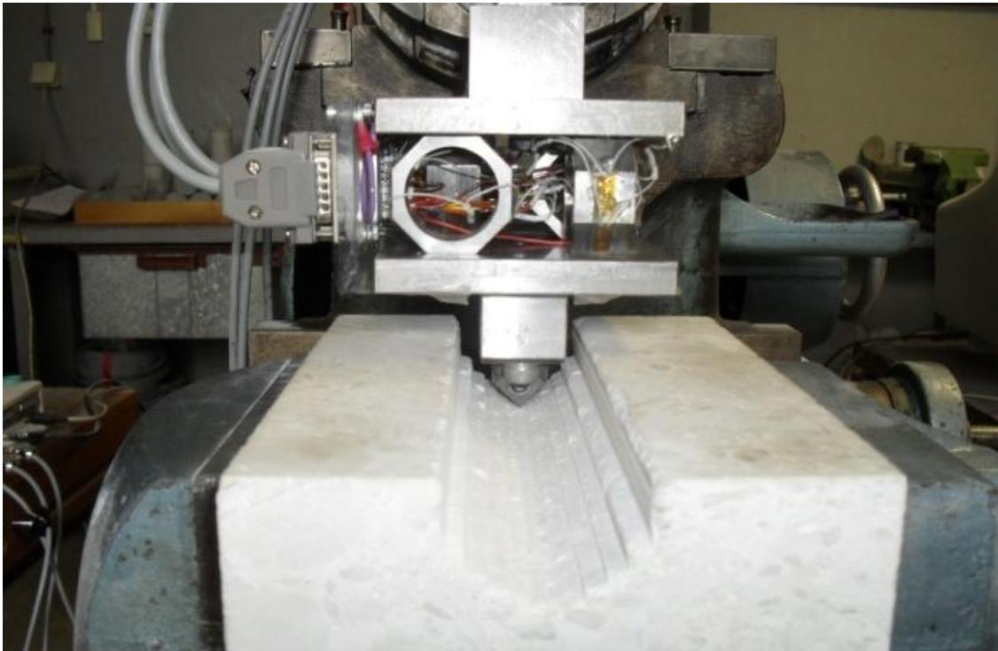
Slika 6.19. Simulacija procesa rezanja.
