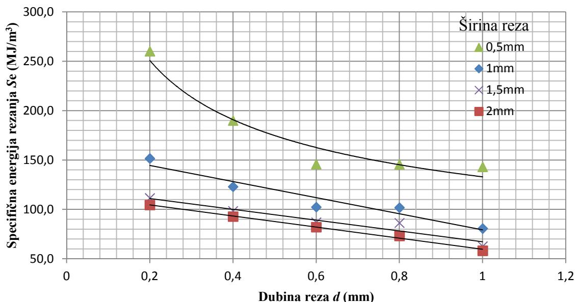
Slika 6.26. Utjecaj dubine rezanja na specifičnu energiju rezanja.
