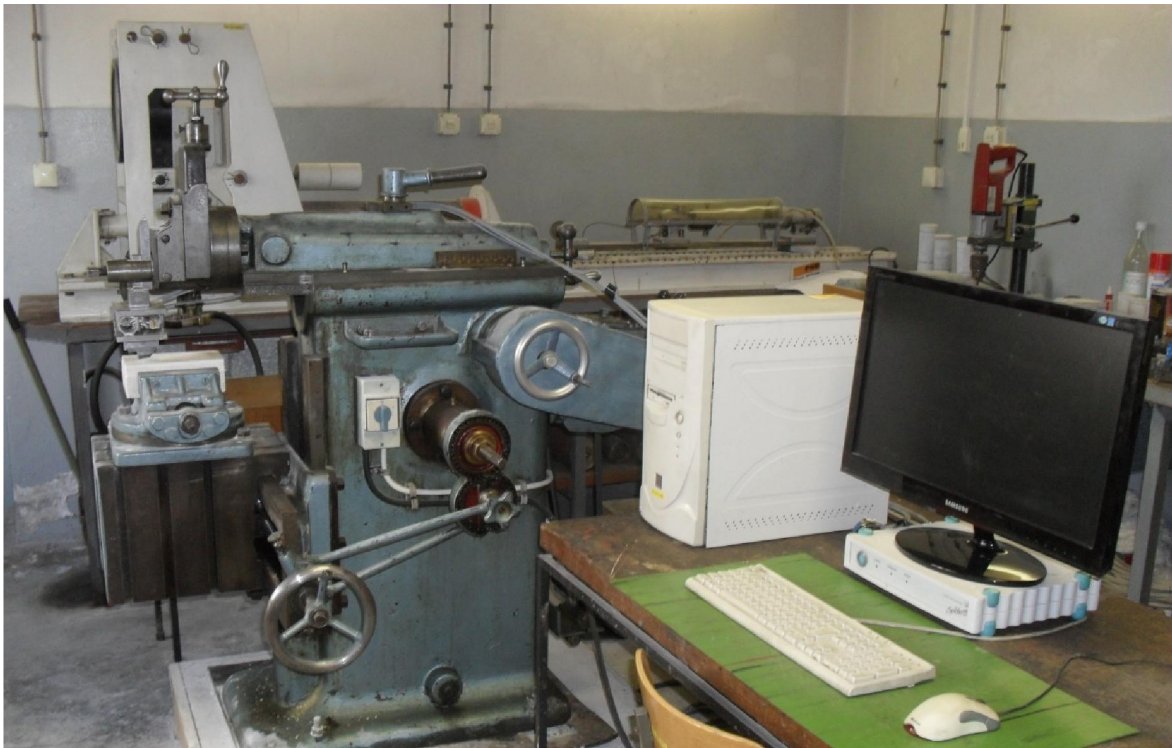
Slika 6.2. Uređaj za pravolinijsko rezanje stijena i mjerni sustav.
