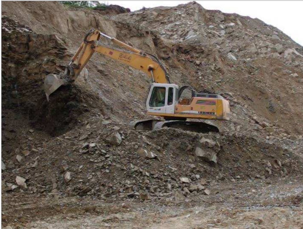
Slika 2.4 Rad bagera na dobivanju otkrivke
