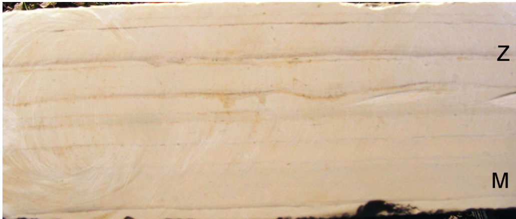
Sl.5.75. Benkovački kamen (mikritni litotip) obrađen piljenjem i brušenjem.
