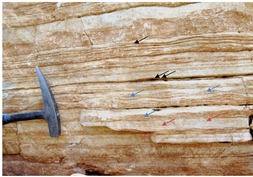
Sl.5.1. Slojne granice (strelica) i otvorene slojne plohe (dvije strelice) u ležištu N-kamen. U presjeku je vidljiva paralelna (crvene strelice) i kosa laminacija strujnih riplova (plave strelice).
