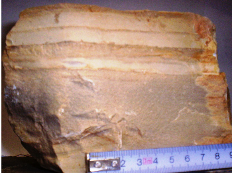
Sl.3.3. Uzorak benkovačkoga prirodnoga kamena s vidljivo naglašenom nehomogenošću u obliku izmjene svjetlijih i tamnijih slojeva/lamina različitog sastava bez otvorenih slojnih ploha.
