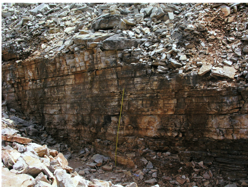
Sl.3.2. Prikaz raskopa u istražnom prostoru N-kamen - izmjena slojeva debljine od 1 do 45cm.
