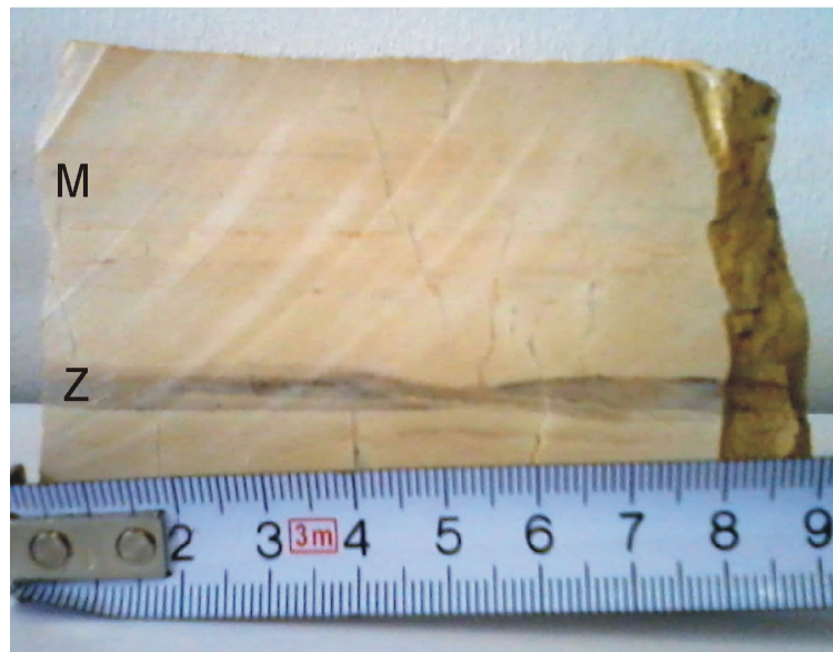
Sl.5.15. Makroskopski izgled mikritnog litotipa (tamna lamina u donjem dijelu uzorka odgovara zrnskom litotipu).
