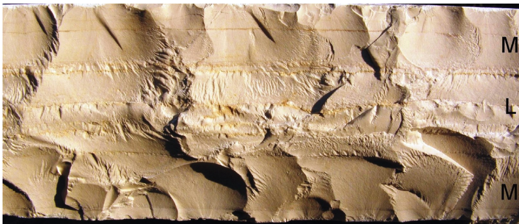
Sl.5.74. Benkovački kamen (laminirani litotip) ručno obrađen. Uočava se karakterističan školjkast lom, mikritnih lamina (proslojaka).
