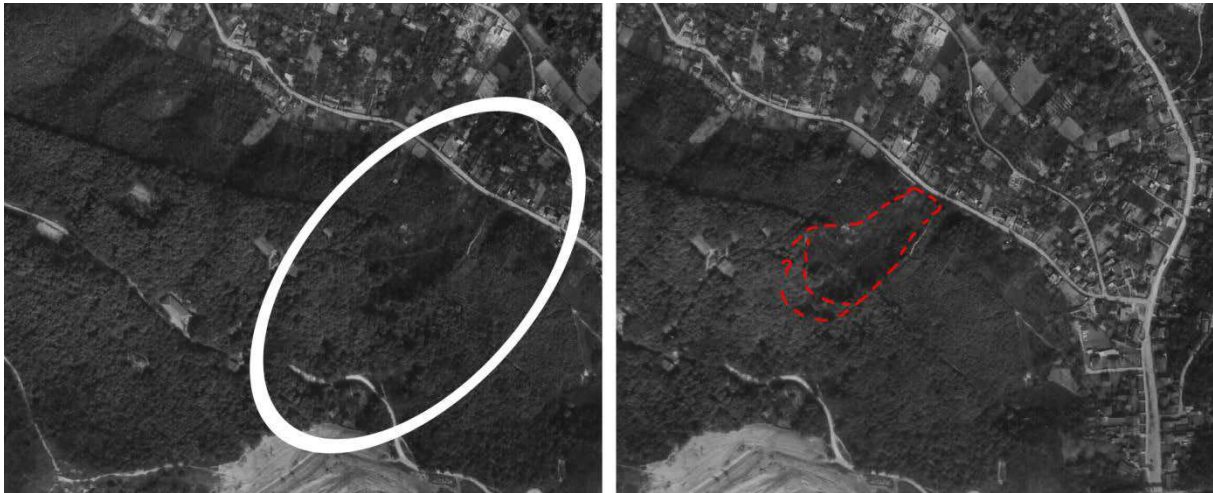
Slika 89 Stereogram klizišta broj 640207 na padini južno od ulice Graberje prema stereomodelu iz 1964. godine s označenom širom klizišta (elipsa na lijevoj slici) i vidljivim elementima klizišta (crvene linije na desnoj slici)
