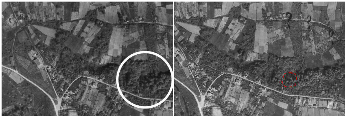
Slika 101 Stereogram klizišta broj 640978 na padini sjeverno od ulice Gospočak prema stereomodelu iz 1964. godine s označenom širom lokacijom klizišta (elipsa na lijevoj slici) i vidljivim elementima klizišta (crvene linije na desnoj slici)
