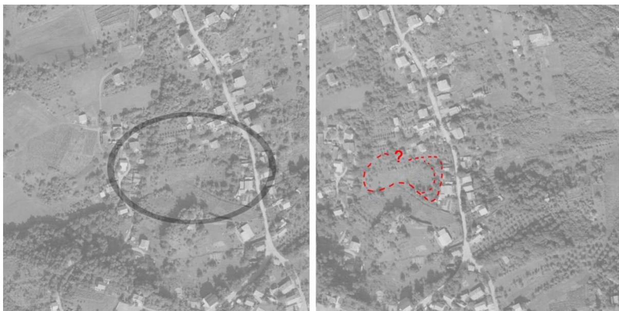
Slika 25 Stereogram klizišta (broj 980440) u Mandićevoj ulici izrađen prema stereoparovima aerosnimki iz 1998. godine s označenom širom lokacijom (elipsa na lijevoj slici) i identificiranim elementima klizišta (crvene linije na desnoj slici) koji su slabije vidljivi zbog izgrađenosti zemljišta
