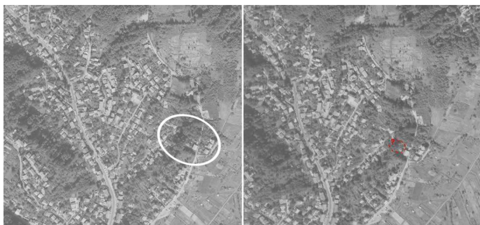
Slika 87 Stereogram klizišta broj 980123 u Kvaternikovoj ulici (kod k.br. 49) prema stereomodelu iz 1998. godine s označenom širom lokacijom klizišta (elipsa na lijevoj slici) i vidljivim elementima klizišta (crvene linije na desnoj slici)
