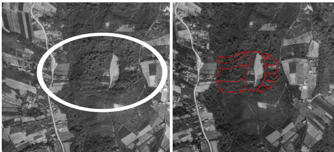
Slika 24 Stereogram klizišta (broj 640207) na lokaciji Veliki potok izrađen iz stereoparova aerosnimki iz 1964. godine s označenom širom lokacijom (elipsa na lijevoj slici) i identificiranim elementima klizišta (crvene linije na desnoj slici) koji su vidljivi zbog razlika u šumskom pokrovu
