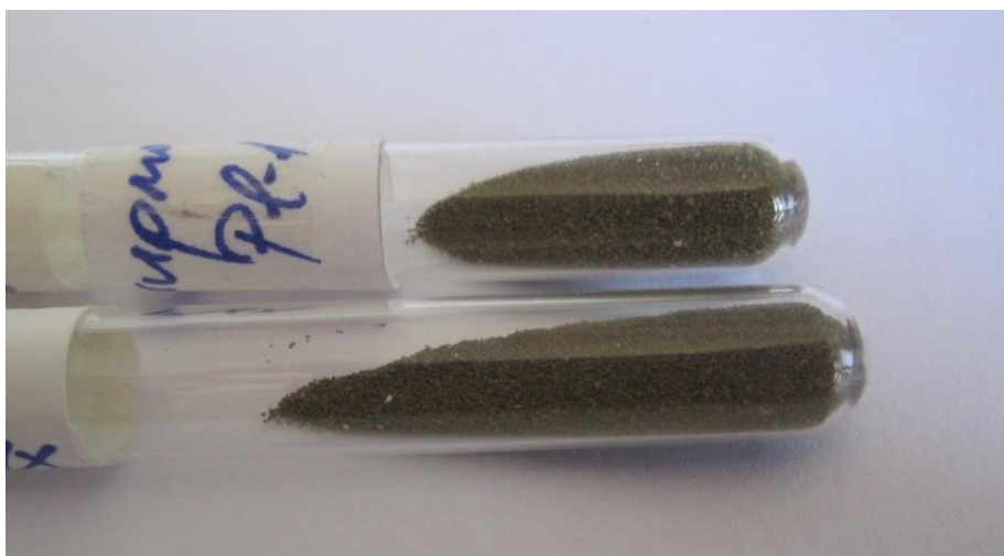
SI. 3.9. Uzorak podijeljen na dvije faze nakon separacije na magnetnom separatoru.
