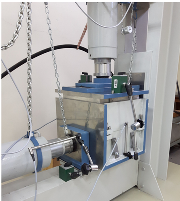
Slika 4-12 LVDT mjerila kojima se prate vertikalni pomaci i horizontalni pomak
