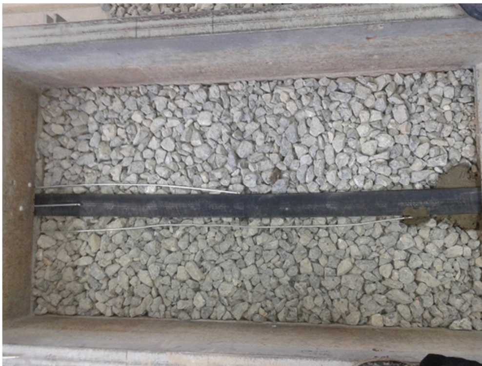
Slika 5-8 Postavljanje ekstenzometara na traku
