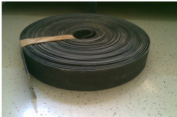
Slika 5-4 Polietilenska – ParaWeb traka korištena u ispitivanju
