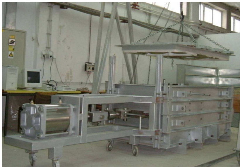
Slika 5-2 Veliki uređaj za ispitivanje otpornosti na izvlačenje (Minažek 2010)
