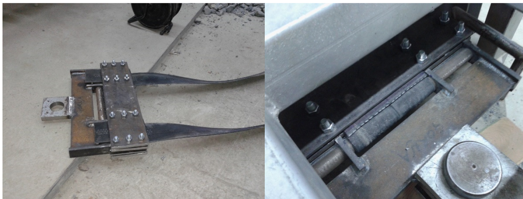
Slika 5-9 Pričvrstni sustav za prihvat dviju razmaknutih i dviju spojenih traka
