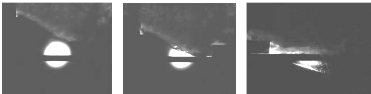
Slika 6-45. Djelovanje mlaza linijskih kumulativnih rezača na metu – snimka I ( http://www.youtube.com/watch?v=ZO_09QdblBY )
