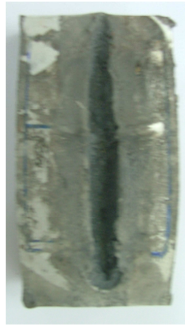
Rez u aluminijskoj meti
