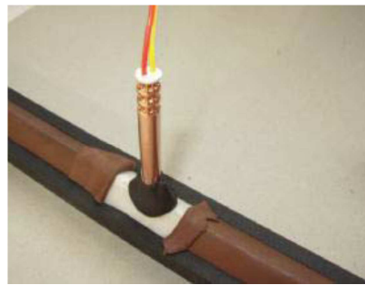
b) detonator okomit na os
