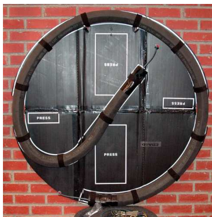
Slika 4-16. Linijski kumulativni rezač namijenjen za probijanje otvora u zidu.
