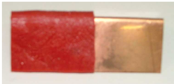
Slika 6-18. Ispitivanje oblika i stanja obloge – mjerni postav I
