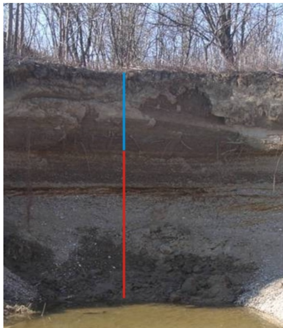
Slika 5.1. Sedimentološko-pedološki profil u nesaturiranoj zoni (modificirano prema Ružičić et al., 2012). Legenda: Plava linija– tlo (oko 2 m); crvena linija – šljunci i pijesci (oko 3,5 m).
