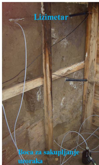
Slika 5.14. Lizimetar s bocom za uzorkovanje perkolirane otopine trasera.
