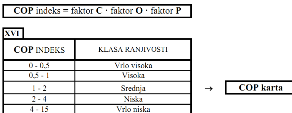
Slika 6.26. Prikaz određivanja COP indeksa i klasa ranjivosti (prema: Vias et al., 2006 )
