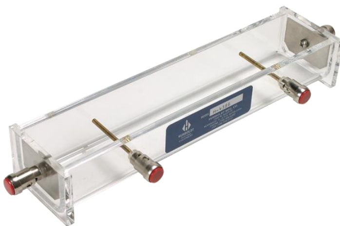
Slika 3-6. Ćelija za mjerenje električne otpornosti ( https://www.humboldtmetfg.com/soil-box.html )
