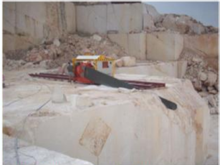
b) početak reza u smjeru nagiba sloja
