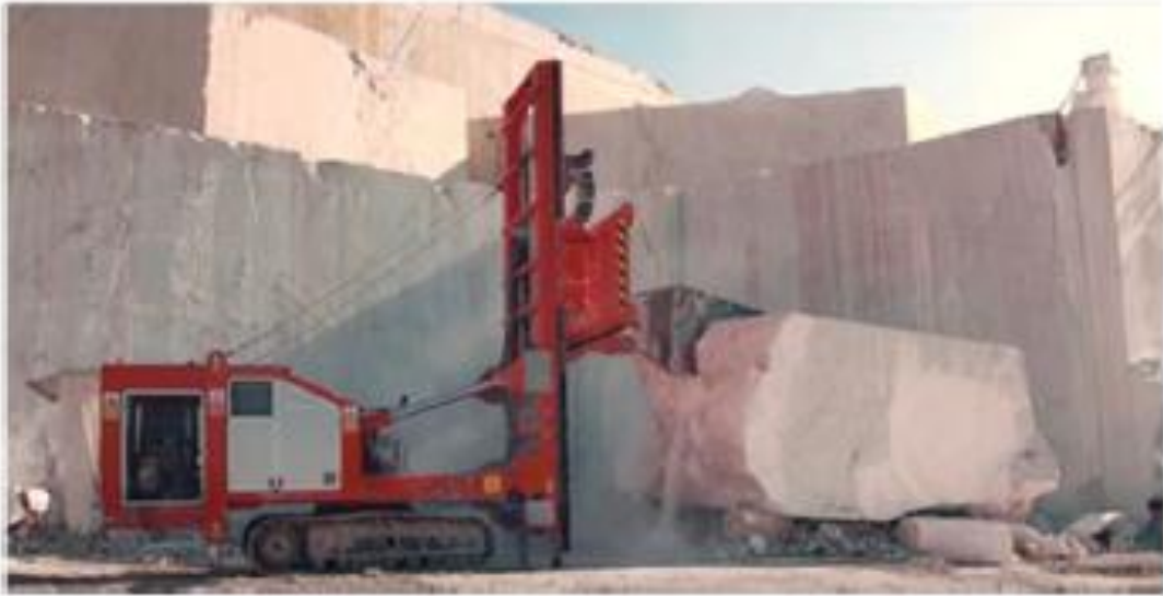
Slika 7-4 Dobivanje završnog bloka sjekačicom
