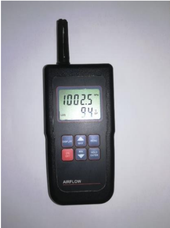
Slika 5-1. Termo-Hygro barometrom THB 4130D.
