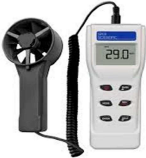
Slika 2-2. Digitalni krilni anemometar (Klanfar, 2017).
