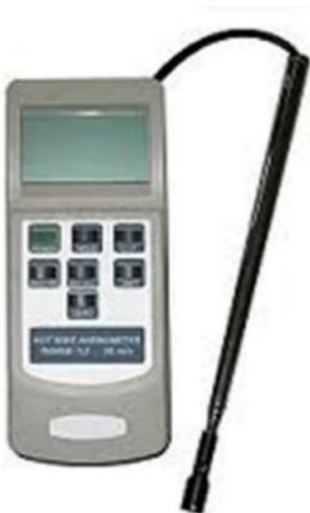
Slika 2-3. Anemometar s grijaćim elementima (Klanfar, 2017).
