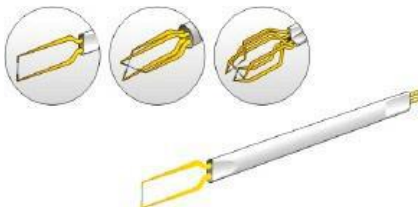
Slika 2-4. Sastavni dijelovi sonde koja sadrži osjetnik od žice (Hegeduš, 2016).
