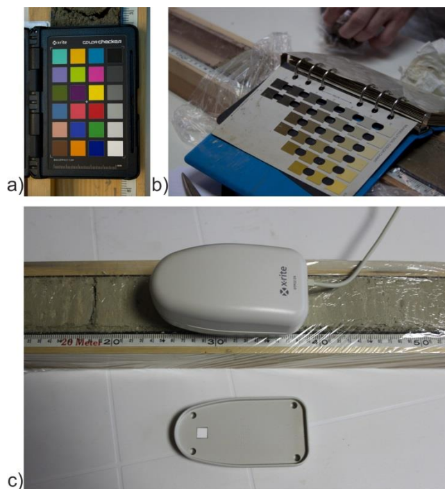
Slika 4.5. Alati i uređaji za određivanje boje sedimenta: a) paleta boja za kalibriranje digitalnih fotografija X-Rite; b) atlas boja Munsell color; c) spektrofotometar prilikom mjerenja sedimentne jezgre i priloženim kalibracijskim standardom.
