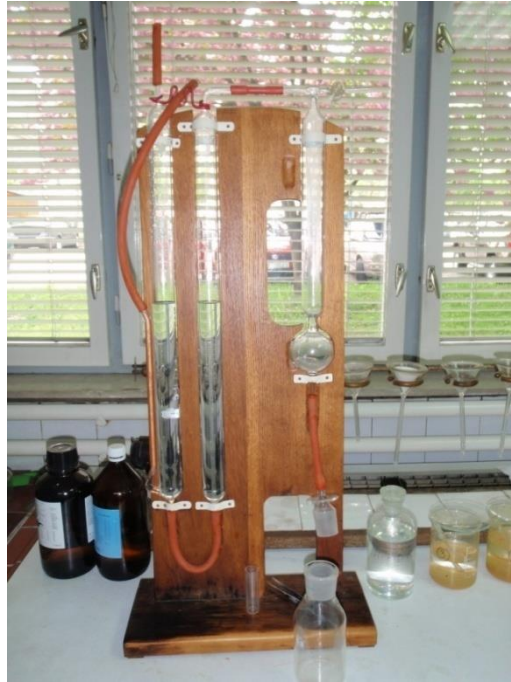
Slika 3-2. Collinsov kalcimetar (foto Gulam).
