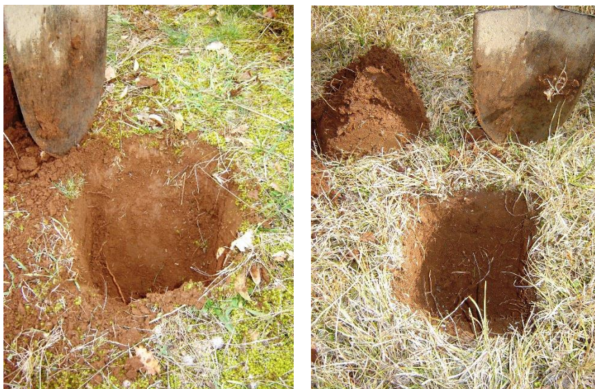
Slika 4.1.1. Primjeri uzorkovanja tla
