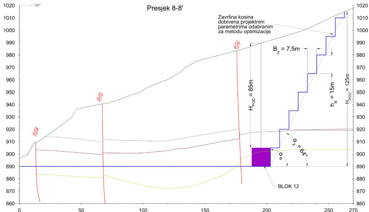
Slika 44 – Prikaz projektnih parametara površinskog kopa na presjeku 8 – 8'
