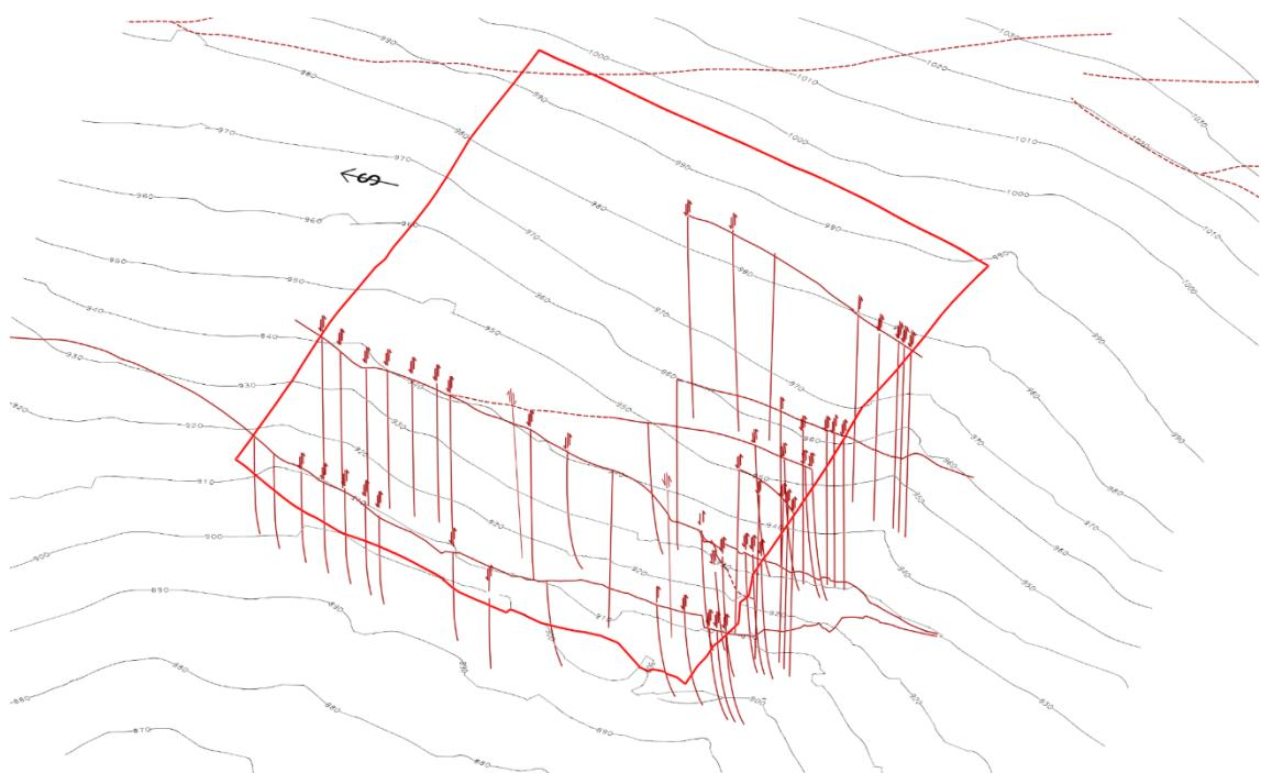
Slika 32 – Elementi korišteni prilikom modeliranja ploha rasjeda
