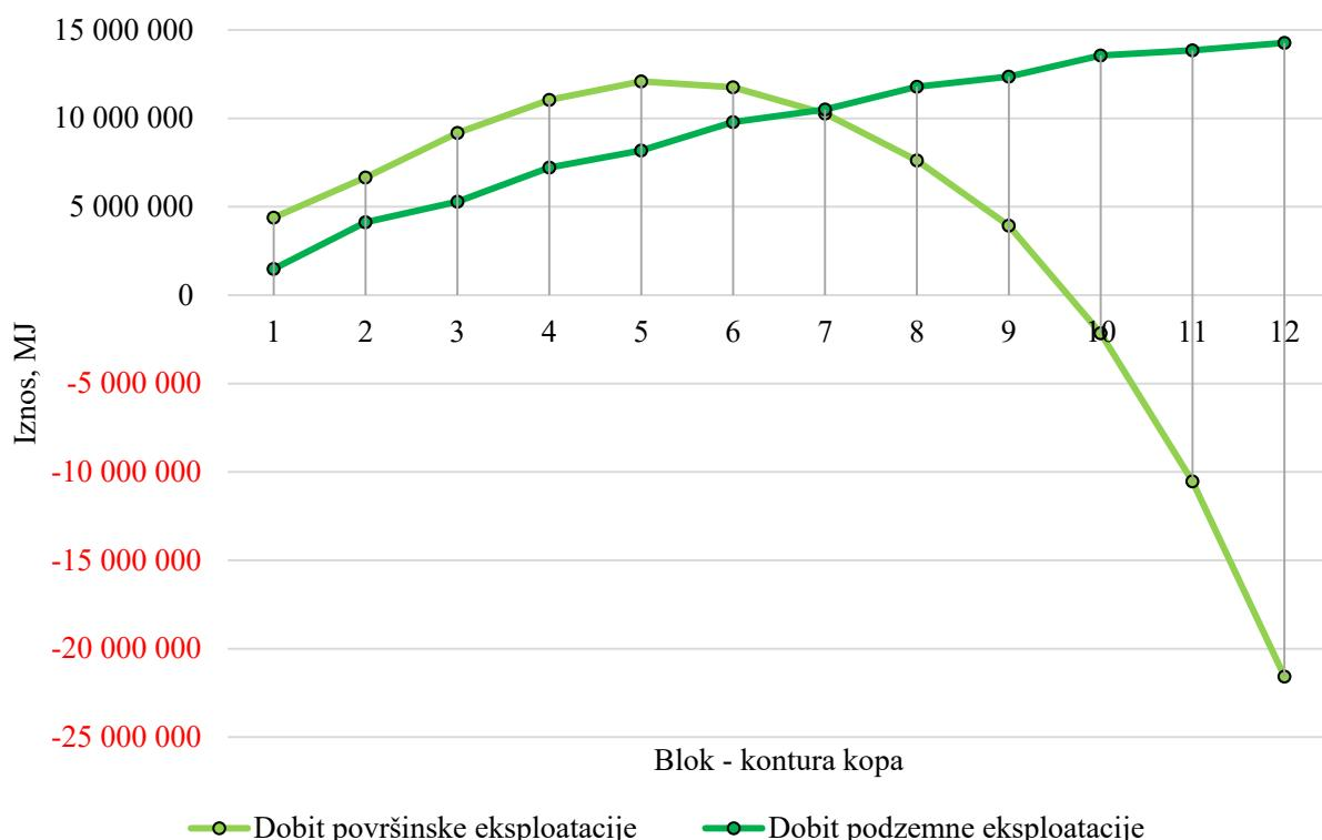
Slika 83 – Dobit od prodaje blokova a-gk površinske i podzemne eksploracije
