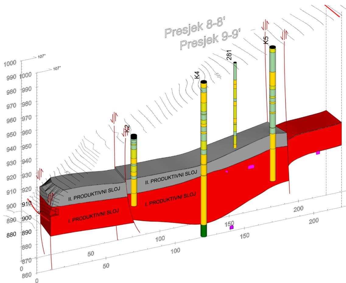
Slika 37 – Modelirani produktivni slojevi između presjeka 8 – 8' i 9 – 9'
