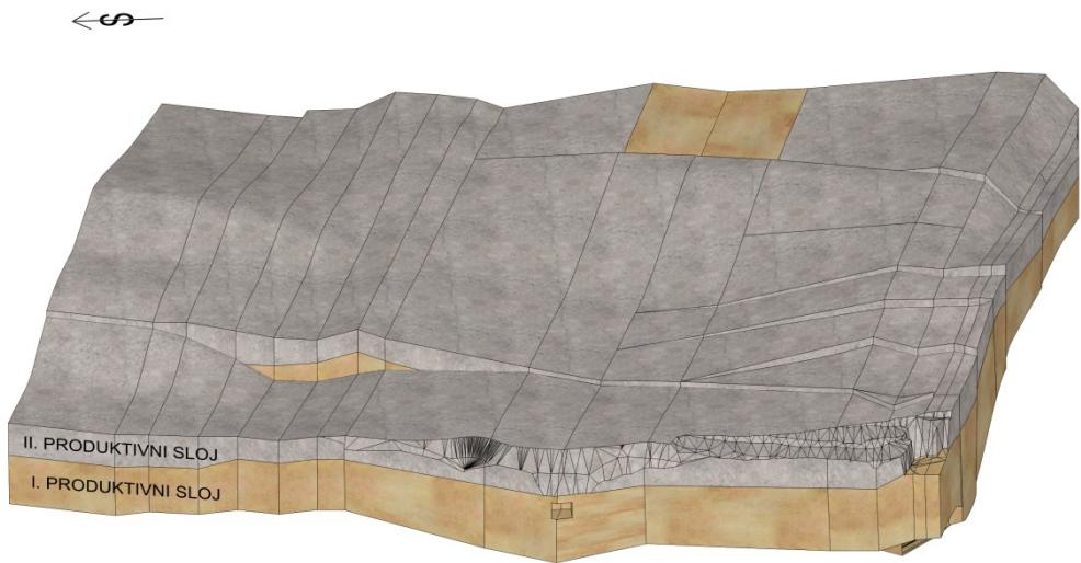
Slika 38 – Modelirani produktivni slojevi ležišta arhitektonsko-građevnog kamenog Crvene stijene
