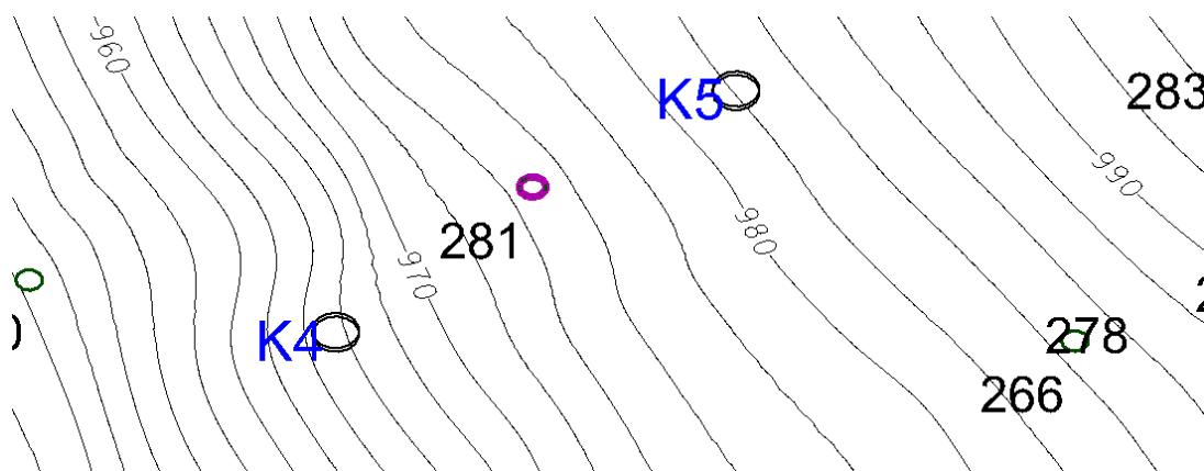
Slika 15 – Pozicionirano ušće bušotine 281 na ispravnoj X-Y-Z poziciji
