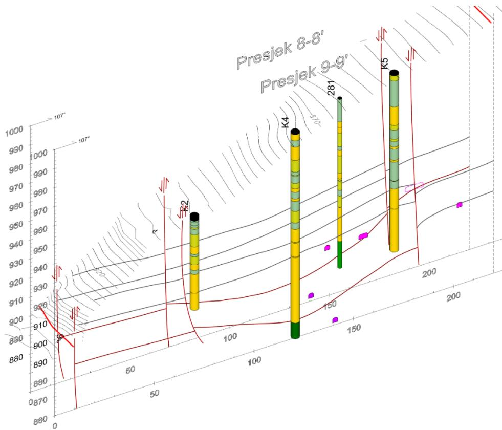
Slika 34 – Izdvojeni elementi korišteni pri modeliranju produktivnih slojeva
