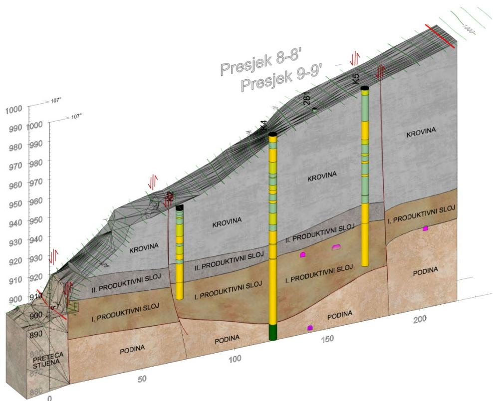
Slika 40 – Modelirani dijelovi ležišta između presjeka 8 – 8' i 9 – 9'
