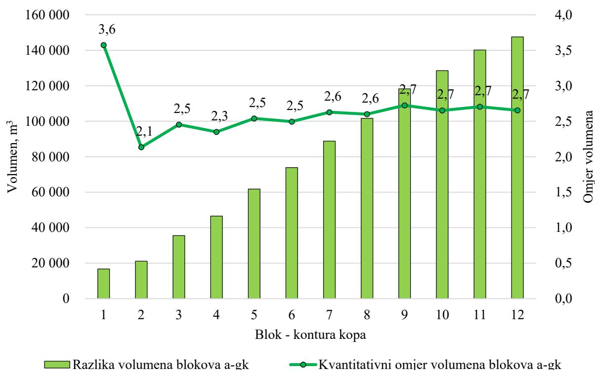
Slika 76 – Kvantitativni odnos volumena blokova površinske i podzemne eksplotacije
