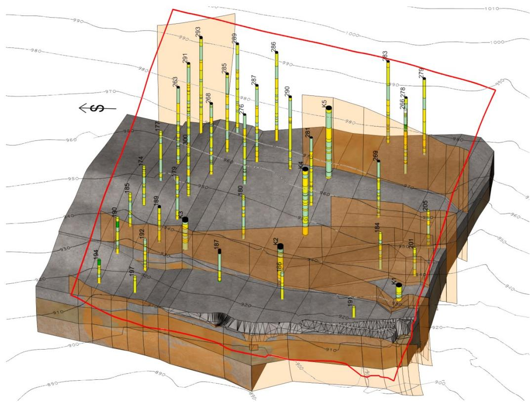
Slika 39 – Modelirani produktivni slojevi arhitektonsko-građevnog amena s prikazom bušotina i rasjeda
