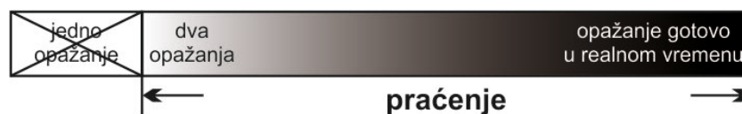
Slika 2.1. Definicija praćenja kao sustavnog ponavljanja opažanja (Stumpf i dr., 2011).
