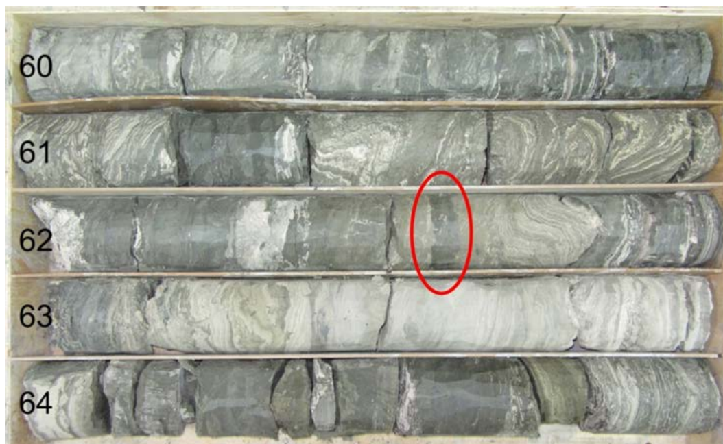
Slika 5.17. Interval jezgre bušotine B-1 od 60 do 65 m s označenom zonom klizne plohe.
