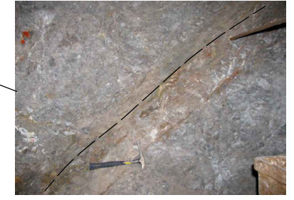
Brečirani dolomit, stariji rasjed, desni bok, 27-30 m
