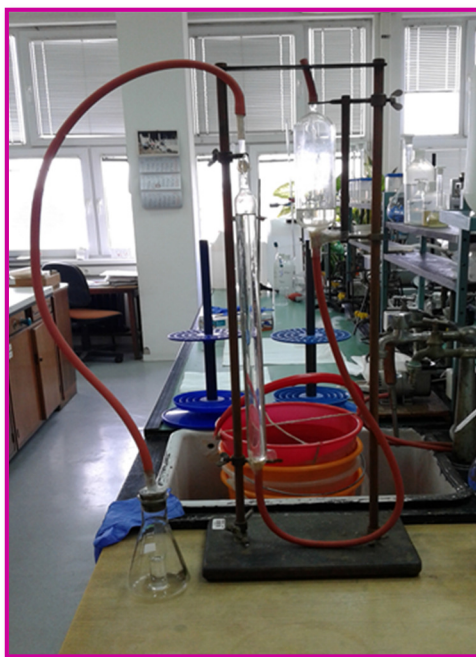
Slika 3-7. Scheibler-ov kalcimetar (foto: Trebeš, 2016)
