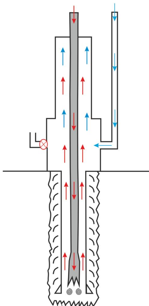
**Slika 5-2.** Shematski prikaz metode broj 2 kod određivanja vrijednosti pada tlaka u vodu za prigušivanje zbog trenja (prilagođeno prema: WCS, 2002)
