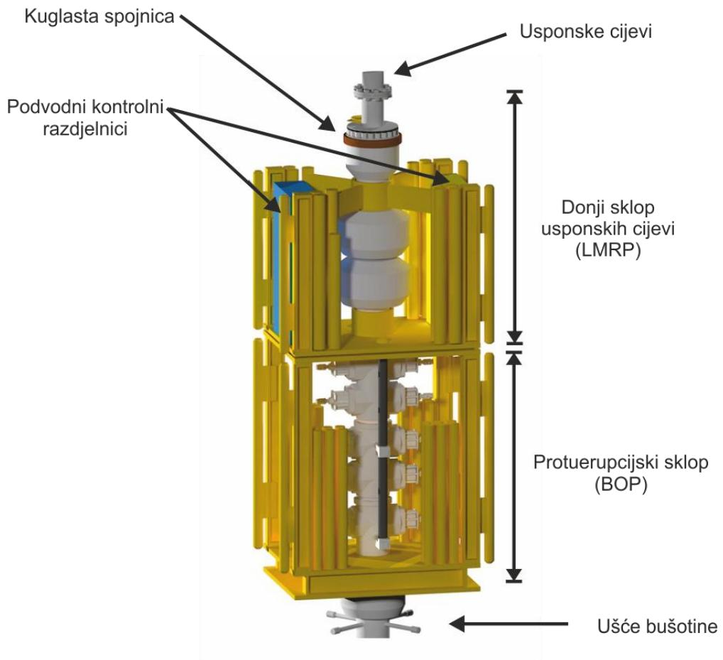
**Slika 2-2.** Kompletan podvodni protuerupcijski sklop (prilagođeno prema: Wikimedia, 2017)
