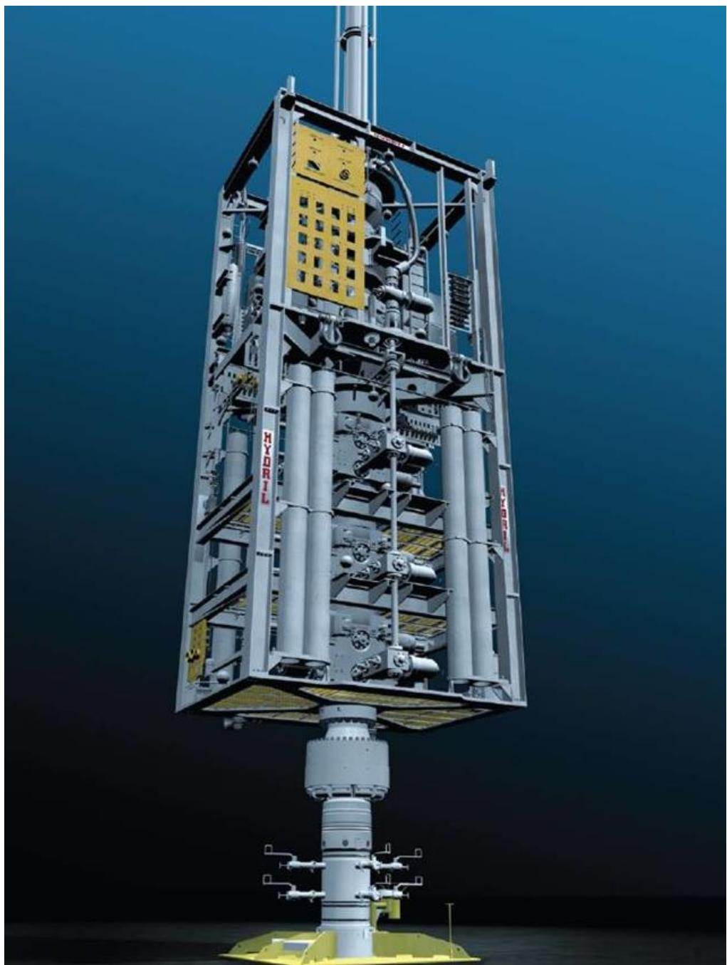
**Slika 2-1.** Podvodni sustav za kontrolu tlaka (Barlow, 2017)
