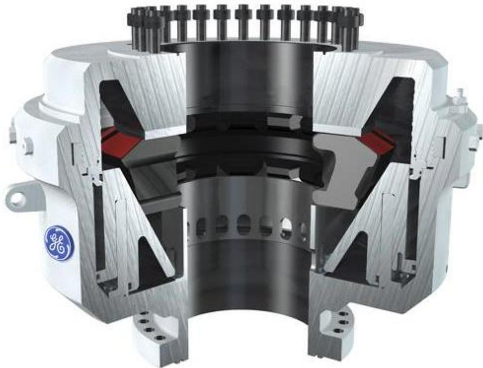
**Slika 4-1.** GE MSP<sup>TM</sup> diverter za srednje radne tlakove unutarnjeg promjera 749,3 mm (GE Oil & Gas, 2017)
