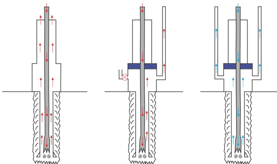
**Slika 5-1.** Shematski prikaz metode broj 1 kod određivanja vrijednosti pada tlaka u vodu za prigušivanje zbog trenja (prilagođeno prema: WCS, 2002)
