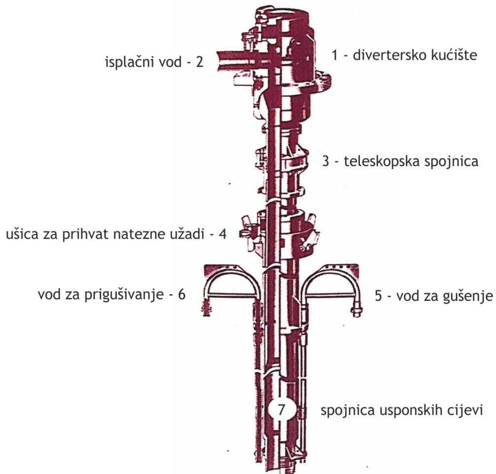
**Slika 4-2.** Dijelovi diverterskog sustava (prilagođeno prema: WCS, 2002)
