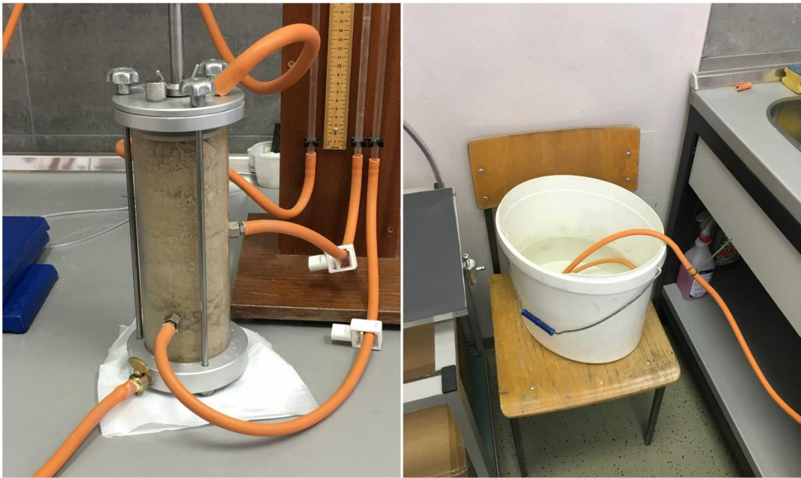
Slika 4-8 Spajanje ćelije na manometar, spremnik za vodu i vakumsku pumpu
