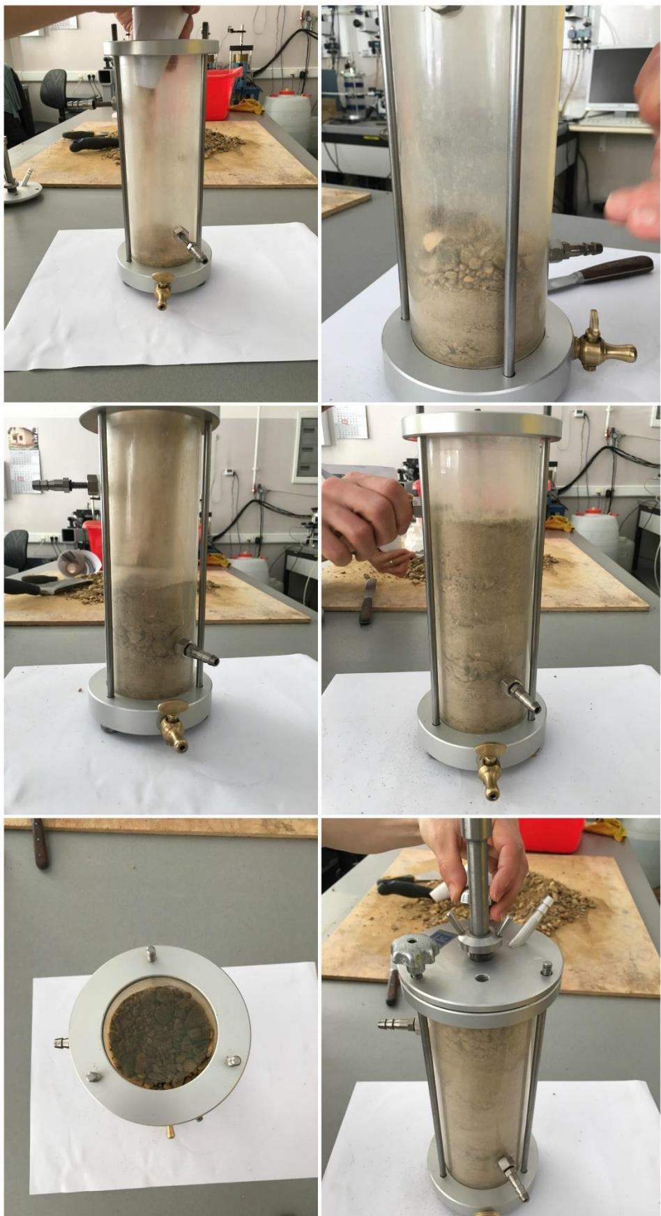
Slika 4-7 Ugradnja uzorka
