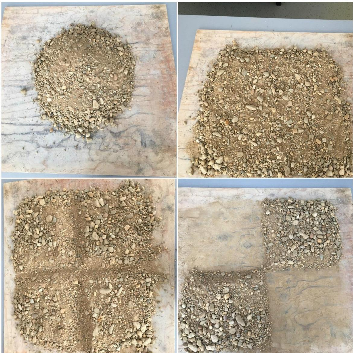
Slika 4-5 Postupak četvrtanja
