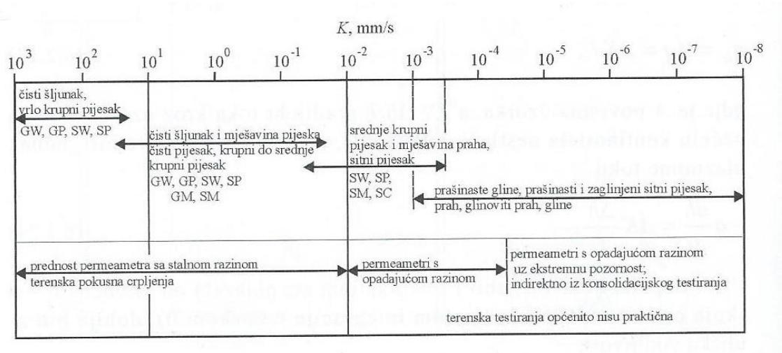
Pri laboratorijskome određivanju hidrauličke vodljivosti permeametrom pojavljuju se brojne poteškoće u dobivanju pouzdanih rezultata. Pri istraživanju te pri interpretaciji rezultata istraživanja treba voditi računa o sljedećim ograničenjima:
