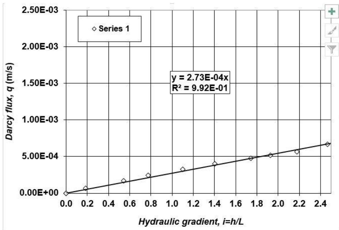
Slika 5-1 Graf ovisnosti specifičnog protoka i hidrauličkog gradijenta
