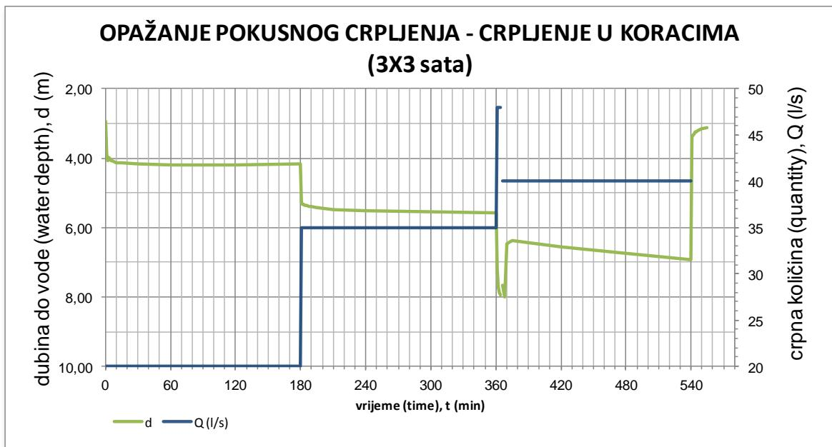
Slika 2-7 Dijagram kolebanja nivoa vode tijekom crpljenja u koracima u istražno-eksploatacijskom zdencu ZŠ-3/16, mjereno izvedeno 24.11.2016 (FIL.B.IS. projekt d.o.o., 2016)
