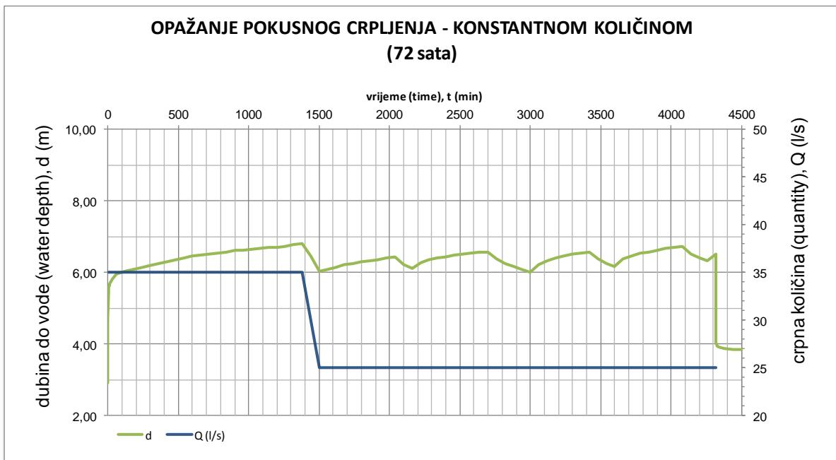
Slika 2-8 Dijagram kolebanja nivoa vode tijekom crpljenja sa stalnom crpnom količinom u istražno-eksploracijskom zdencu ZŠ-3/16, mjereno izvedeno 25.11.2016 – 28.11.2016 (FIL.B.IS. projekt d.o.o., 2016)
