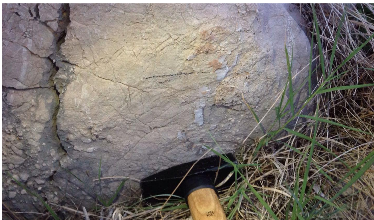
Slika 4-5. Rasjedna ploha Fortičkog rasjeda sa stepenastim agregatima vlaknastog kalcita koji ukazuju na lijevi pomak po rasjedu) (GPS koordinate N 44° 19' 32,35'' E 15° 15' 14,60'')
