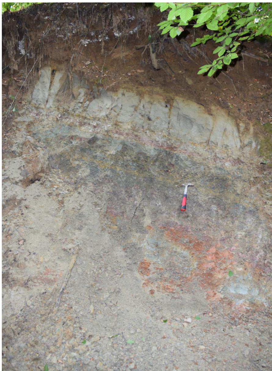
Slika 5.3: Profil kroz pijeske i gline (pokrupnjavanje naviše)
