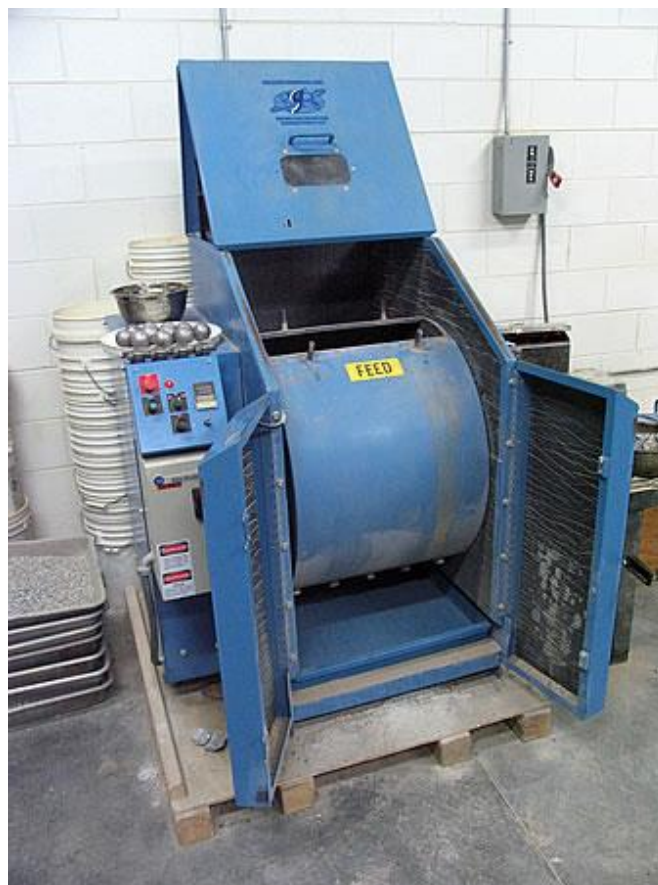
Slika 4-1. Rotirajući bubanj za ispitivanje abrazivnosti u sklopu LA metode (Pavia systems 2012).
