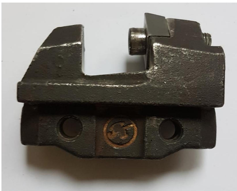
Slika 6-11. Nosaĉ rezne ploĉice proizvoĉaĉa Korfmann.
