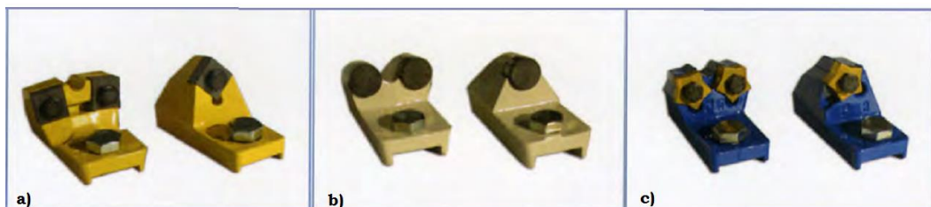
Slika 2-8. Rezne pločice, a) kvadratičnog oblika, b) kružnog oblika, c) zvjezdastog oblika (Primavori 2005).
