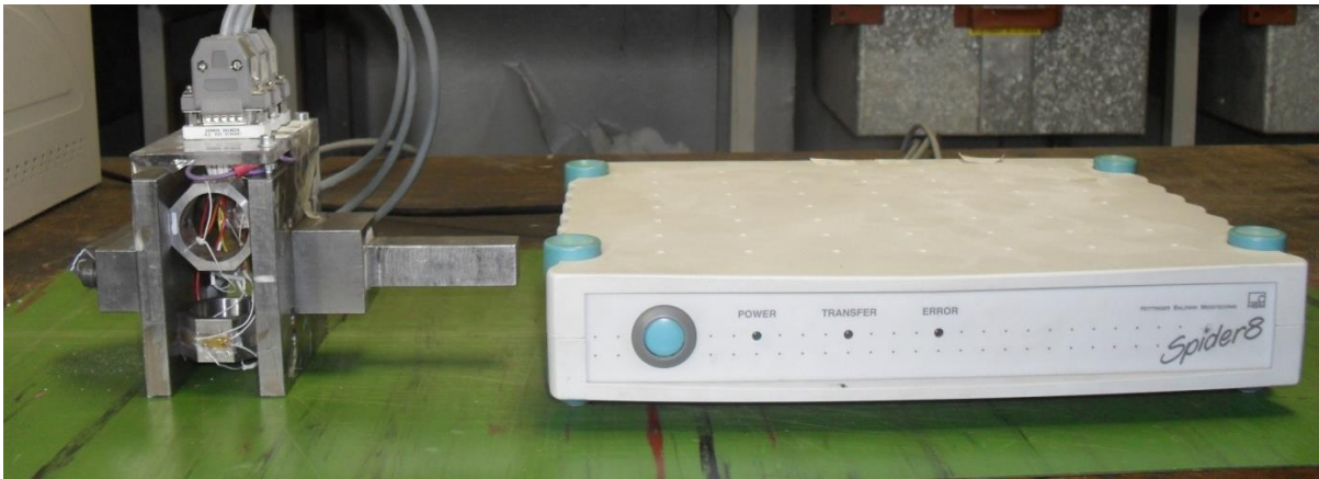
Slika 6-4. Mjerni sustav za ispitivanje rezivosti stijenske mase (Korman 2014).
