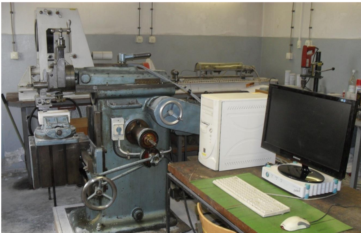
Slika 4-4 Uređaj za pravolinijsko rezanje stijena i mjerni sustav (Korman, 2014).
