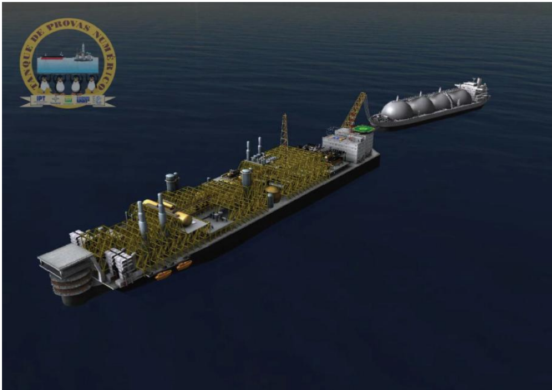
Slika 5-6. Tandemsko povezivanje sa sustavom opterećenja pramca (Teles et al., 2010)
