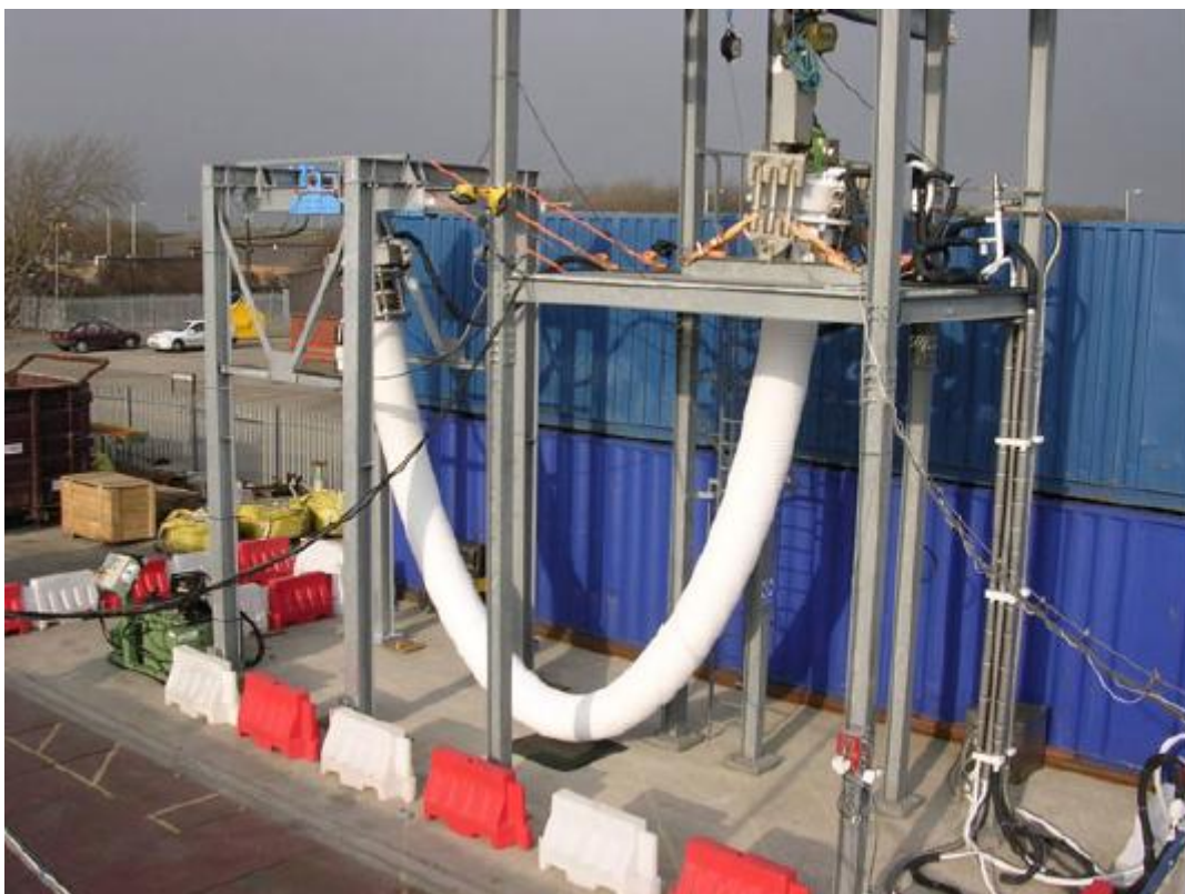
Slika 5-4. Testiranje 16“-og kriogenog zračnog crijeva (Caswell et al., 2010)
