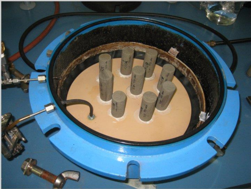
Slika 4-1. Aparatura za mjerenje kapilarnih tlakova metodom polupropusne membrane (Perković, 2011)
