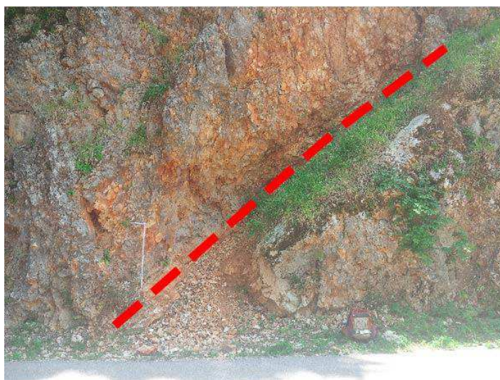
Slika 5-24. Rasjed u foraminiferskom vapnencu na točki D 26 .
