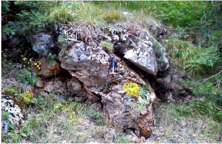
Slika 5-2. Izdanak stijene jedinice Sis s vidljivom slojevitošću na točki opažanja F1.
