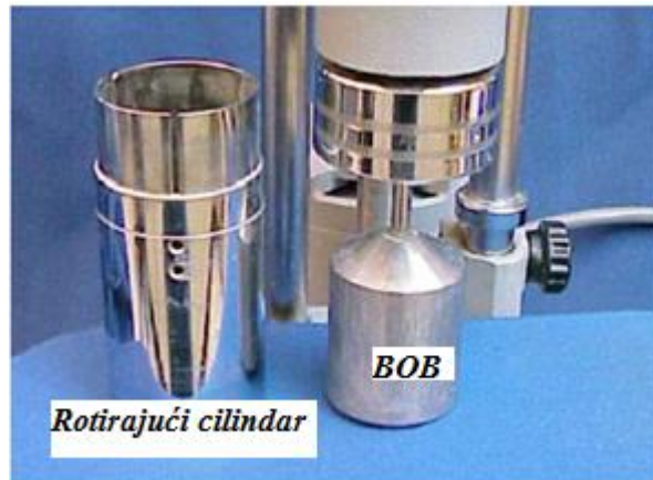
Slika 3-3. Dijelovi Fann viskozimetra (Olowolagba i Brenneis, 2010)
