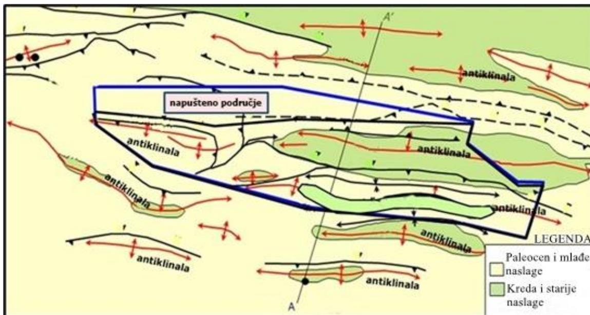
**Slika 6-2.** Karta tektonskih odnosa na području izrade planirane horizontalne bušotine (HKN Energy, 2015)
