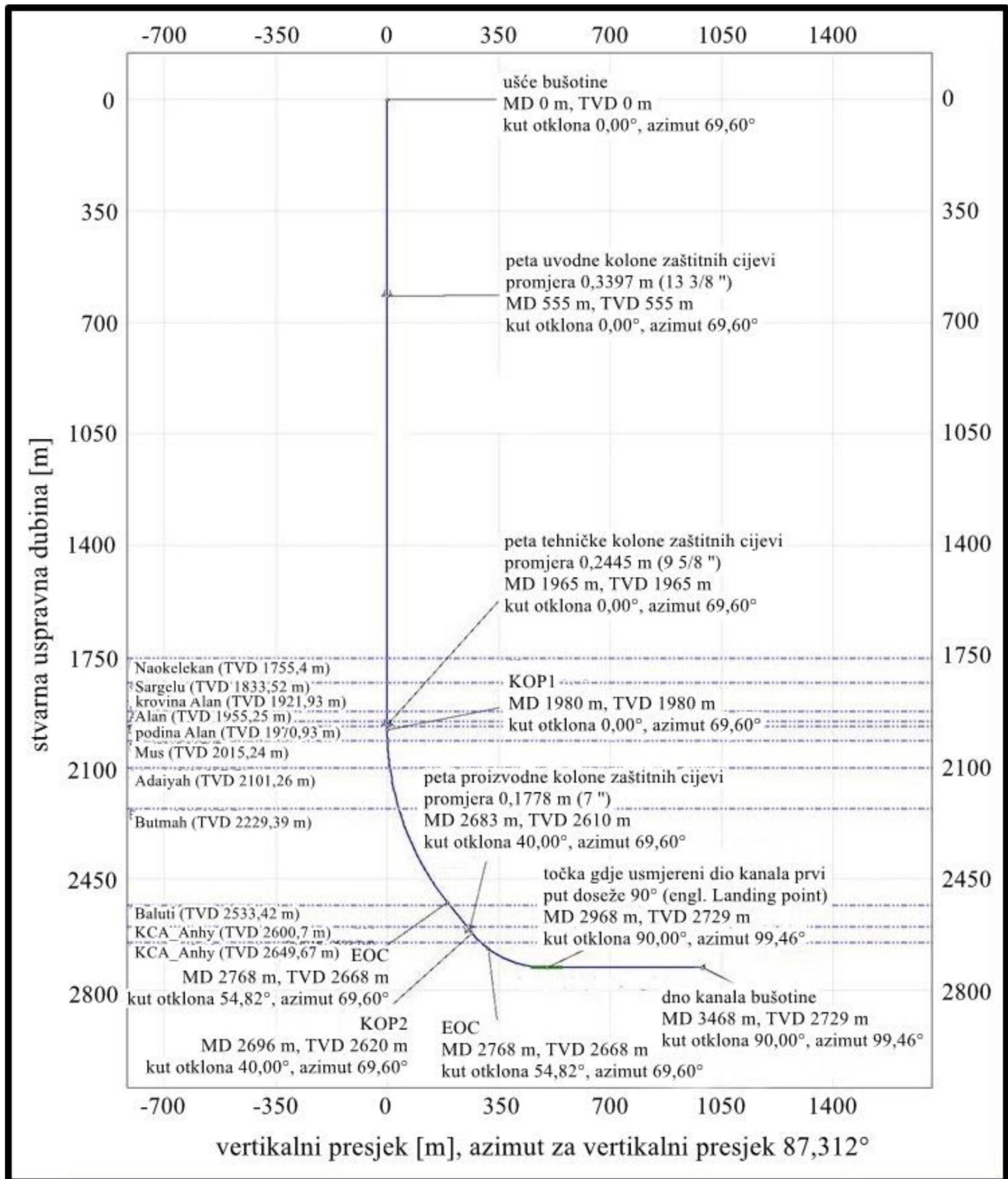
Slika 6-6. Vertikalni profil kanala planirane bušotine (HKN Energy, 2015)
