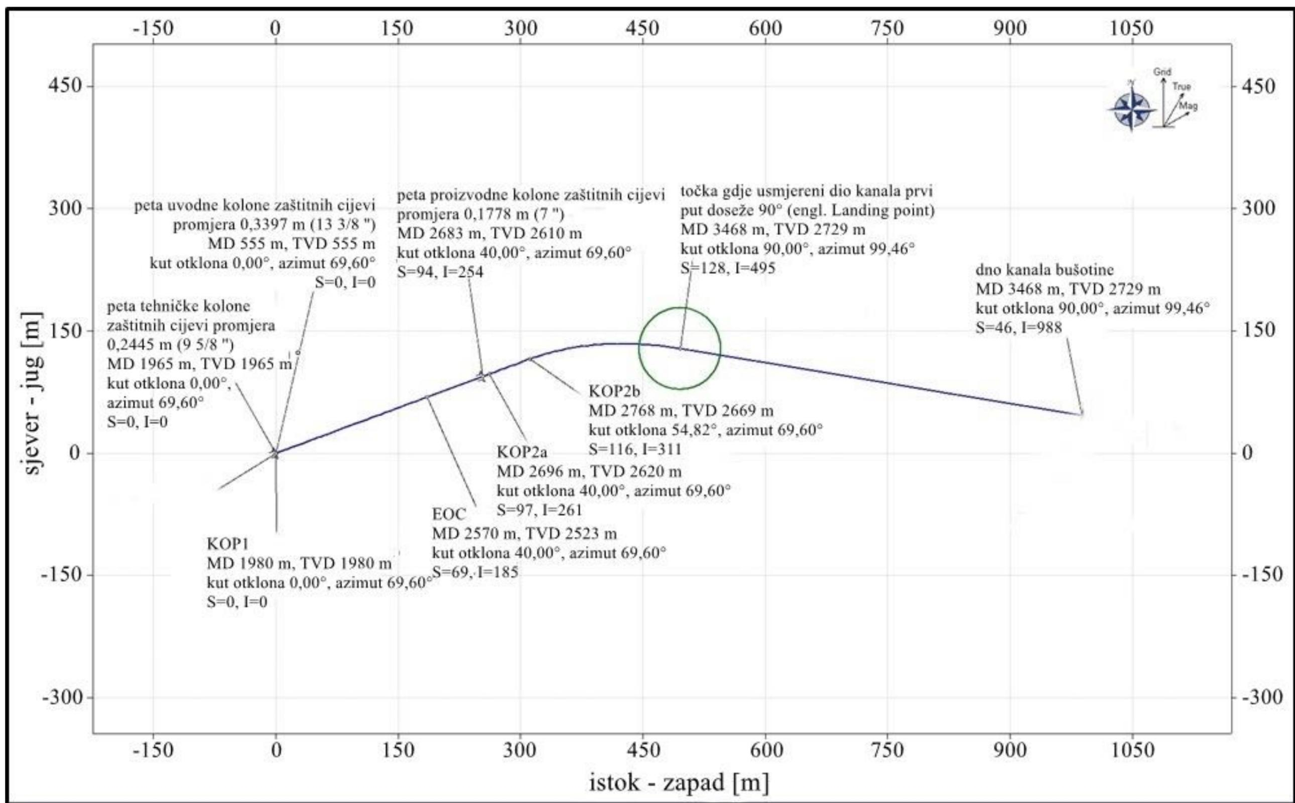
Slika 6-5. Horizontalna projekcija planirane bušotine (HKN Energy, 2015)
