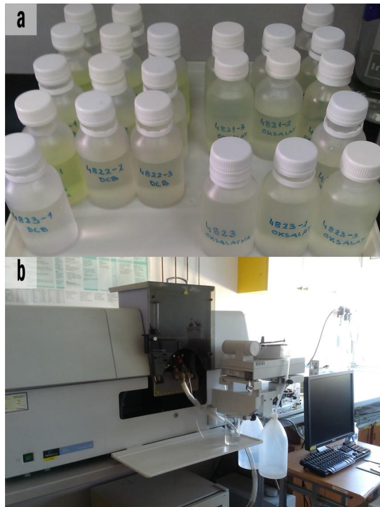
Slika 3.3. (a) Dio uzoraka pripremljenih za mjerenje na AAS-u; (b) Atomski apsorpcijski spektrometar (AAS) Aanalyst 700 Perkin Elmer.
