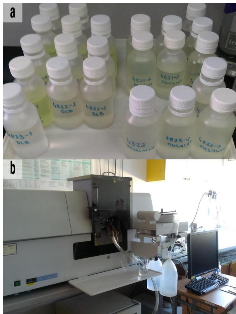
**Slika 3.3. (a)** Dio uzoraka pripremljenih za mjerjenje na AAS-u; **(b)** Atomski apsorpcijski spektrometar (AAS) Aanalyst 700 Perkin Elmer.
