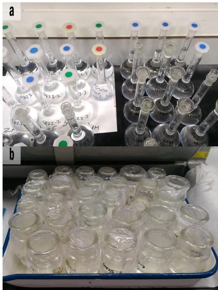
**Slika 3.8. (a)** Ekstrakti tla iz kojih se nakon dodatne pripreme mijere koncentracije izmjenjivih kationa (Na, K, Mg, Ca); **(b)** Ekstrakti tla iz kojih se nakon dodatne pripreme određuje koncentracija magnezija u suvišku te se iz toga izračuna CEC.
