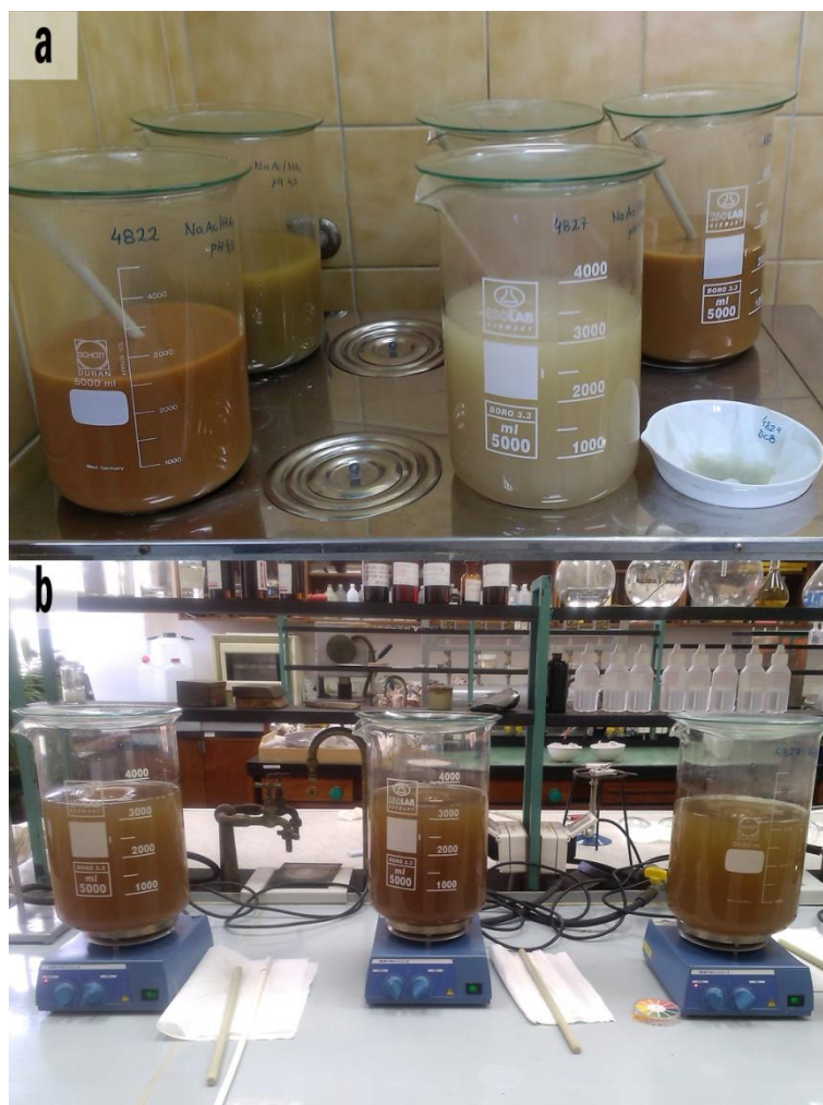
Slika 3.12. (a) Selektivno otapanje karbonata na kupelji; (b) Nastavljeno selektivno otapanje karbonata na magnetnoj miješalici.
