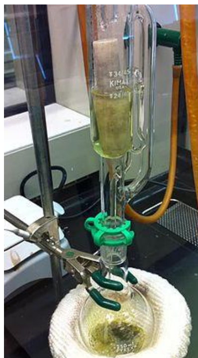
Slika 4-8. Soxhlet-ov ekstraktor s prikazom kruženja otapala (www.wikipedia.com, 2017)
