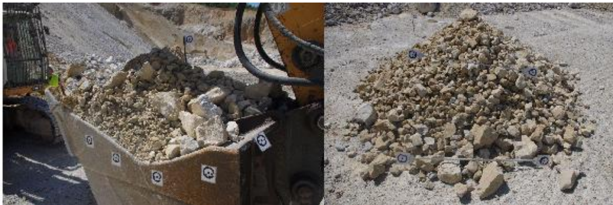
Slika 7-3. Drugo mjerenje; snimanje materijala u lopati (lijevo), snimanje istresene hrpe (desno)
