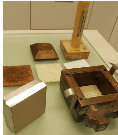
Slika 3-21. (a) Potrebni pribor prilikom ugradnje, (b) Uzorak ugrađen u prsten
