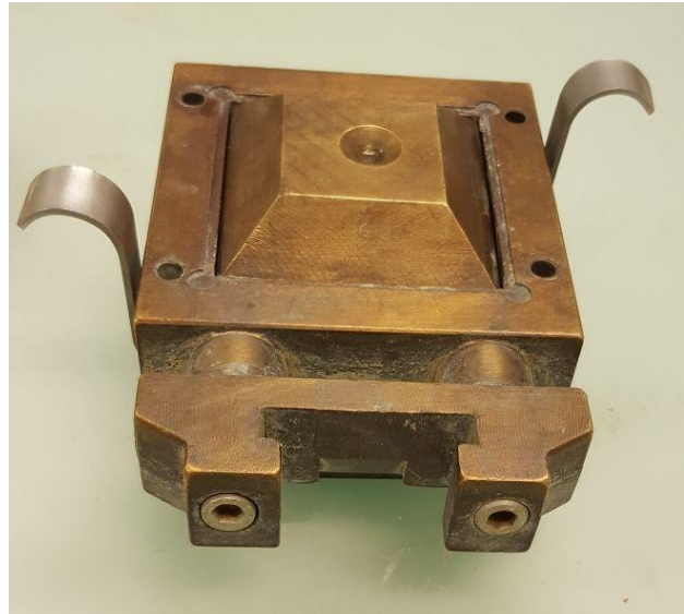
Slika 3-22. (a) Utiskivanje uzorka u kalup, (b) Ugrađen uzorak u kalup
