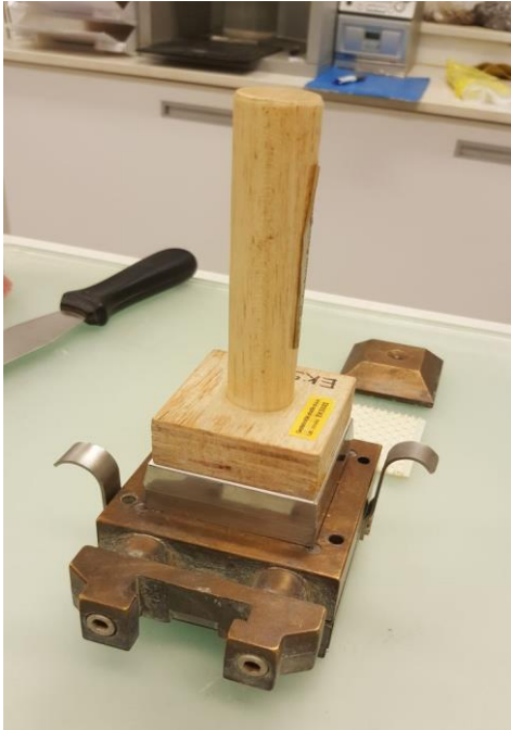
Slika 3-22. (a) Utiskivanje uzorka u kalup, (b) Ugrađen uzorak u kalup
