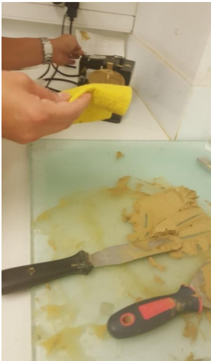
Slika 3-5. a) Priprema uzorka za Casagrandeov pokus, b) Casagrandeov uređaj s uzorkom
