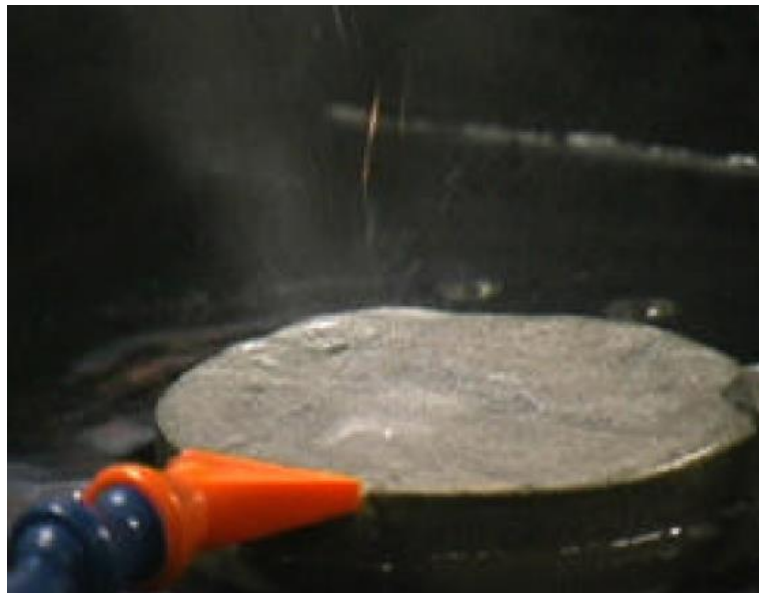
Slika 7-10. Neuspjeli pokušaj laserskog snopa CO 2 lasera da razruši uzorak stijene (Reed et al., 2003)
