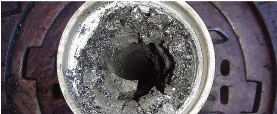
Slika 4-12. Taloženje parafina unutar tubinga (Envirofluid, 2014 b)
