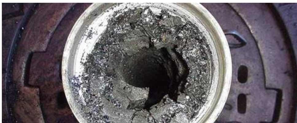
Slika 4-12. Taloženje parafina unutar tubinga (Envirofluid, 2014 b)
