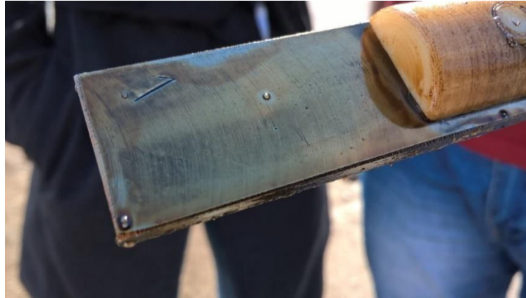
Slika 4-10. Izgled metalnog kupona s proizvodne bušotine nakon 13 dana (INA d.d., 2017 b)
