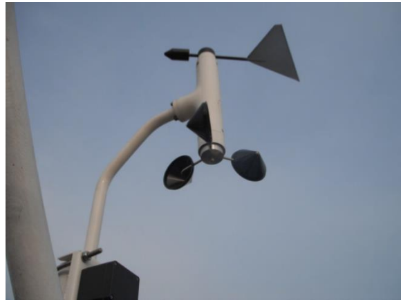
Slika 3-9. Senzori za vjetar na bušačem brodu (Pacific Drilling, 2009)
