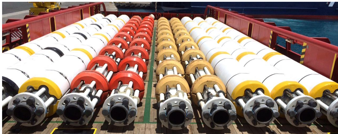
Slika 2-5. Usponske (marine riser) cijevi ( www.multimarine.com.cy , 2015)
