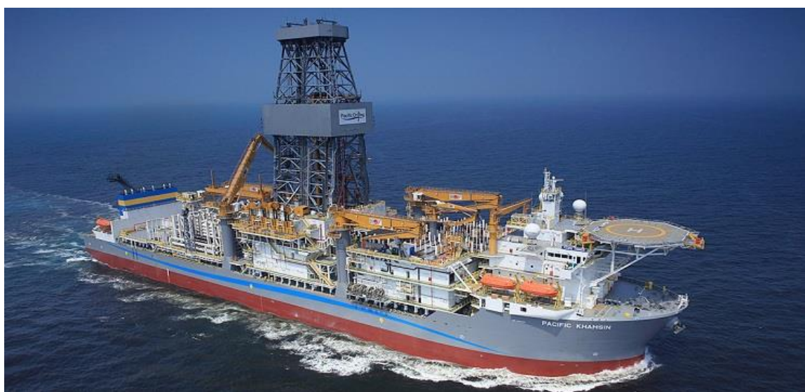
Slika 2-1. Bušaći brod sedme generacije (engl. drillship ) ( www.pacificdrilling.com , 2017a)
