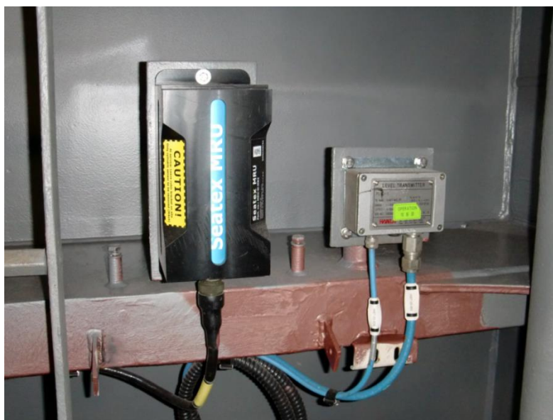
Slika 3-8. Uređaj za praćenje gibanja na bušaćem brodu (Pacific Drilling, 2009)
