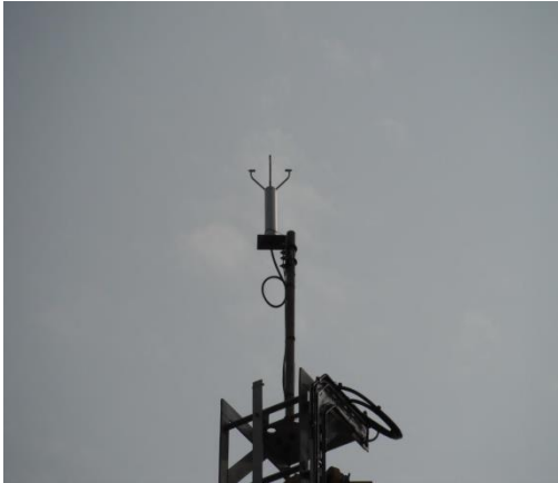
Slika 3-9. Senzori za vjetar na bušačem brodu (Pacific Drilling, 2009)
