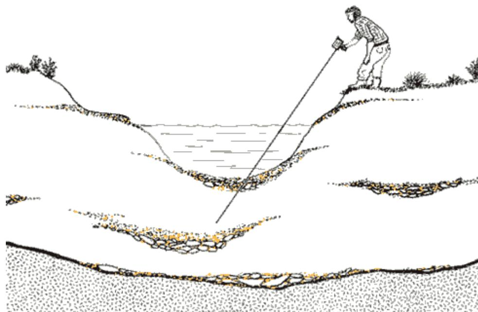
**Slika 5-1.** Princip uzorkovanja Goldspear instrumentom
