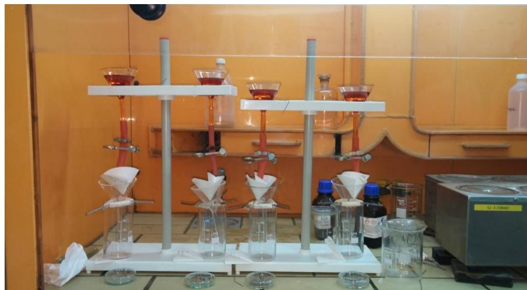
**Slika 5-7.** Separacija mineralnih frakcija bromoformom u digestijskom bloku
