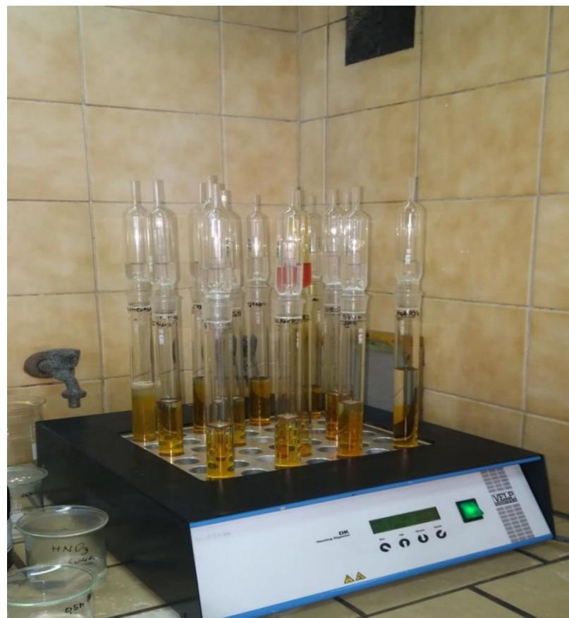
**Slika 5-9.** Reakcijske epruvete sa klopkom na grijaču
