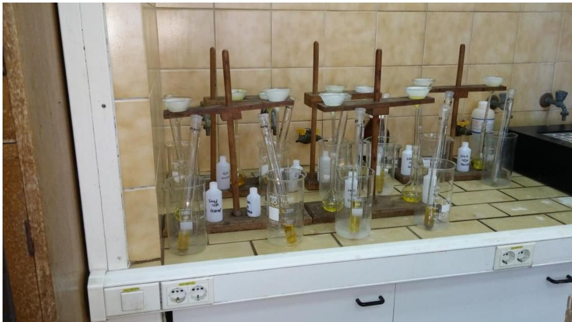
**Slika 5-8.** Slika prikazuje uzorce stavljene u reakcijsku epruvetu sa zlatotopkom
