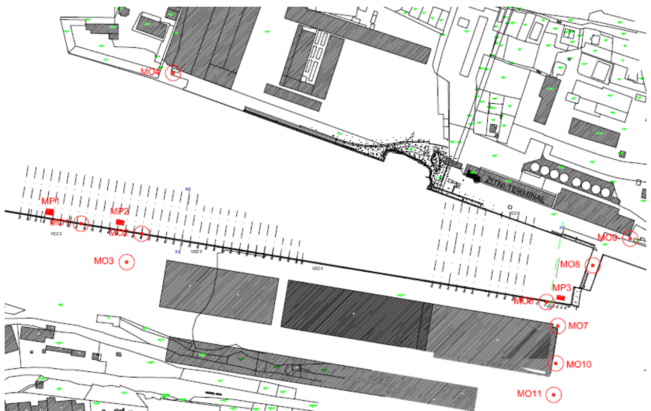
Slika 5-2. – Situacijska karta a ucrtanim minskim poljima i mjernim mjestima za prva tri probna minska polja (Dobrilović, 2018.)
