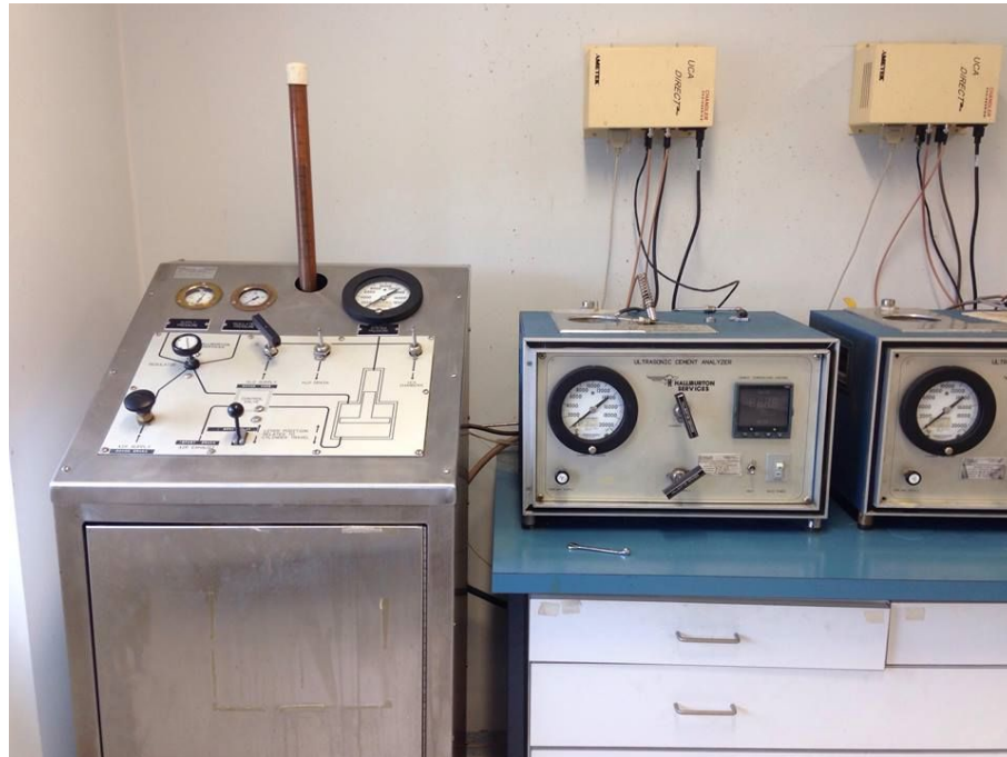
Slika 5-14. Ultrazvučni analizator (UCA) korišten u radu
