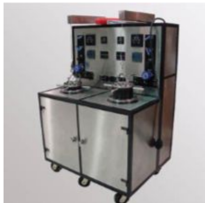
Slika 4-4. Autoklav - komora za stvrdnjavanje
