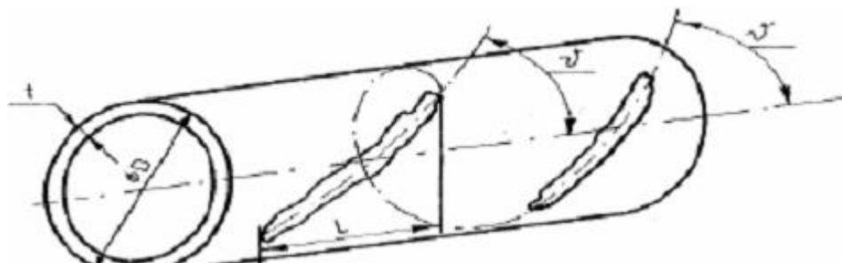
$v$  – kut koji oštećenje zatvara sa centralnom osi cijevi, ( $^{\circ}$ )
