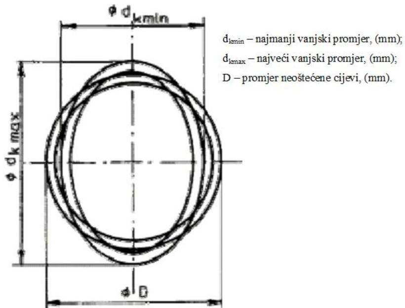
Slika 3-6. Poprečni presjek ovalne cijevi (Hashem, 2018)
