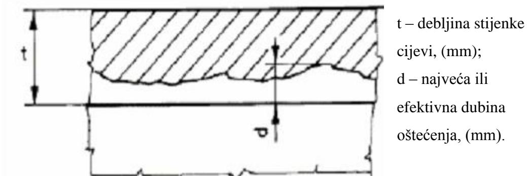
Slika 3-7. Prikaz oštećenja cijevi izazvanog općom korozijom (Hashem, 2018)
