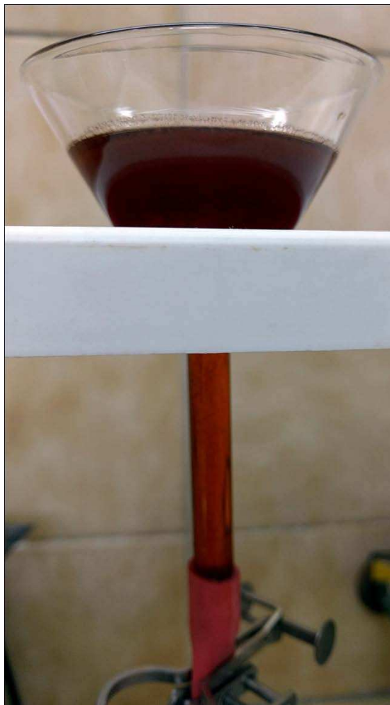
Slika 3.6. Separacija teške mineralne frakcije pomoću bromoforma.
