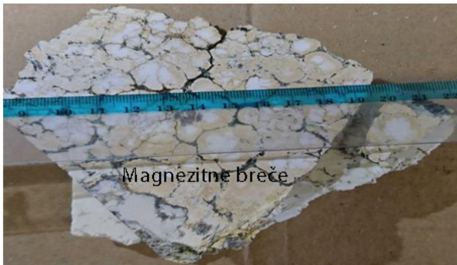
Slika 5.8. Magnezitna breča s magnezitnim valuticama povezanim serpentinsko-kvarcnim matriksom.
