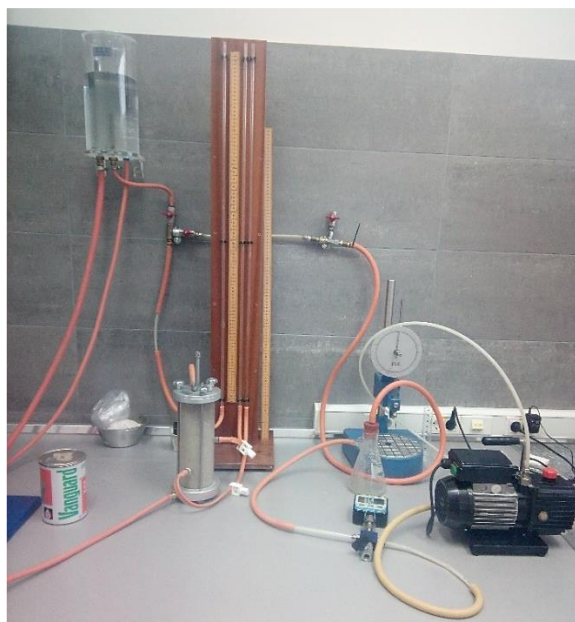
Slika 5.8 Ugradnja uzorka u ćeliju permeametra
